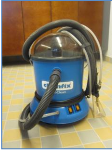
KUVA 4. Painehuuhtelukone (Kuva: Uusitalo Minna 2012)
