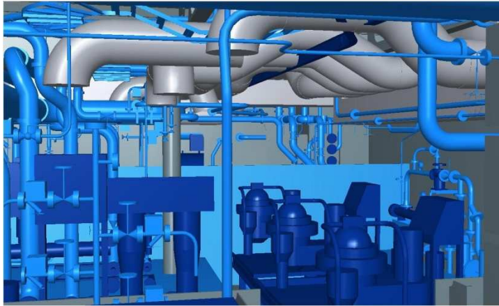
Kuvio 2. Tyypillinen näkymä laivan putkistojen 3D –suunnittelusta ( Peni 2011 ).
