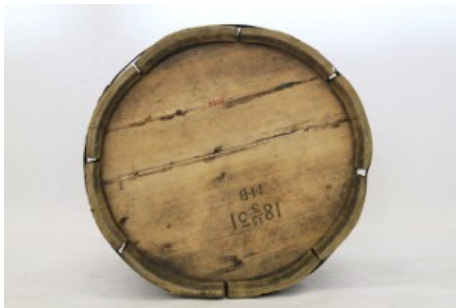
Kuva 42: Kimmimet ovat eläneet ja kaareutuneet yli pohjan kaaren (Rajamäki 2012).
