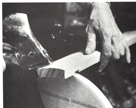
Kuva 23: Pohjan sovittaminen uurteeseen (Vilkuna & Mäkinen 1976: 285).
