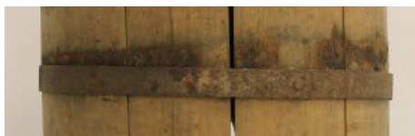
Kuva 38: Astian EY470 vanteen korroosiopintaa ja sen vaikutukset alla olevaan puumateriaaliin (Rajamäki 2012).
