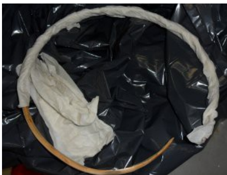
Kuva 65: Vanteen kostuttaminen (Rajamäki 2012).
