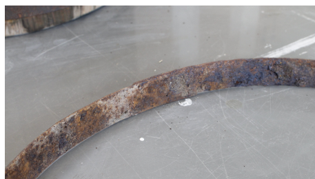
Kuva 53: Korroosiotuotetta irronneessa vanteessa (Rajamäki 2012).
