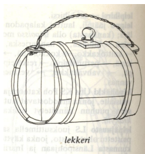
Kuva 5: Tynnyrin mallinen, kaksipohjainen lekkeri (Vuorela 1979: 238).
