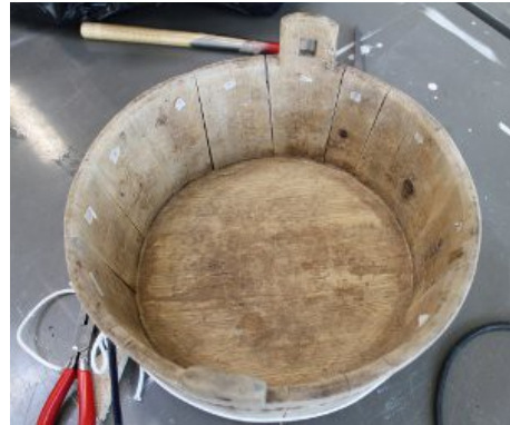
Kuva 67: Pohjan sovittaminen uurteeseen (Rajamäki 2012).
