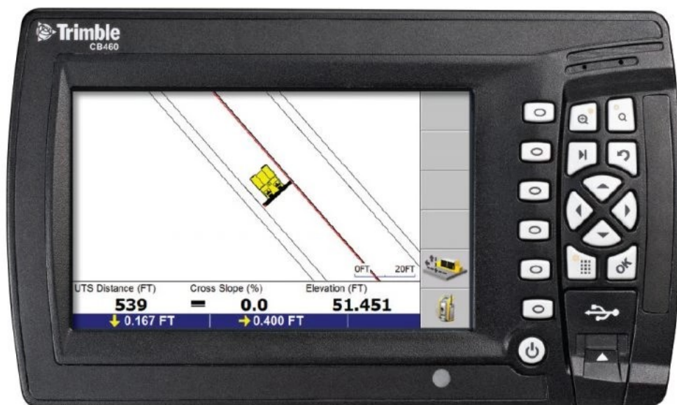
KUVA 10 Levittäjän sijainti työmaalla. (equipmentworld.com)
