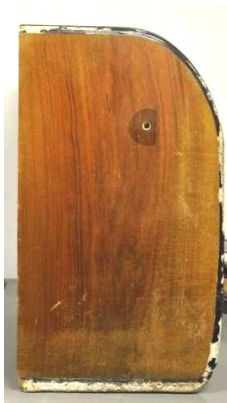
Kuva 15. Radion vanha lakkapinta.
