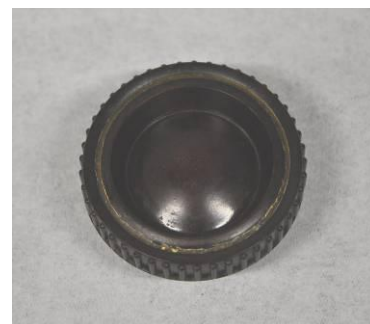
Kuva 36. Paraloid B 72:lla suojat-tu muoviosa. (Kuvat: Kangaskolk-ka 2012)
