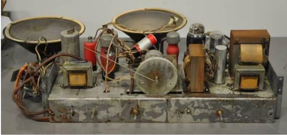
Kuva 44. Radion koneisto puhdistettiin pintapuolisesti varoen sen mekaniikkaa. (Kangaskolka 2012)
