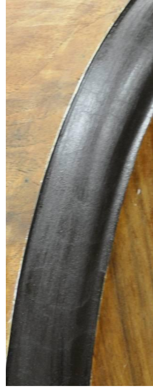
Kuva 31. Pinta täyttyi hiushalkeamista. (Kuvat: Kangaskolkka 2012)
