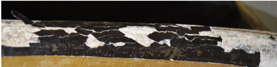
Kuva 28. Lastulevyn päällä ollut vanha pintakäsittely. (Kangaskolka 2012)
