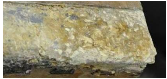
Kuva 27. Siistitty lastulevyypaikkaus. (Kuvat: Kangaskolkka 2012)
