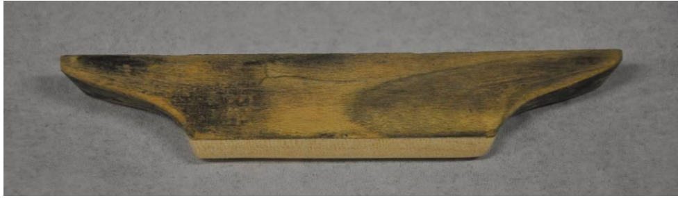
Kuva 22. Vetimeen liimattiin paikkapala lehmuksesta, joka muotoiltiin tyyliin sopivaksi. (Kangaskolkka 2012)
