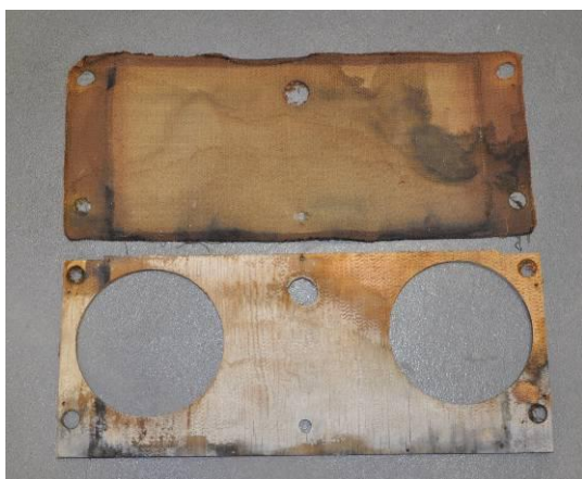
Kuva 39. Kankaan näkyvä osa oli haalistunut. Se oli kiinnitetty suoraan vanerille eläinliimalla. (Kangaskolka 2012)
