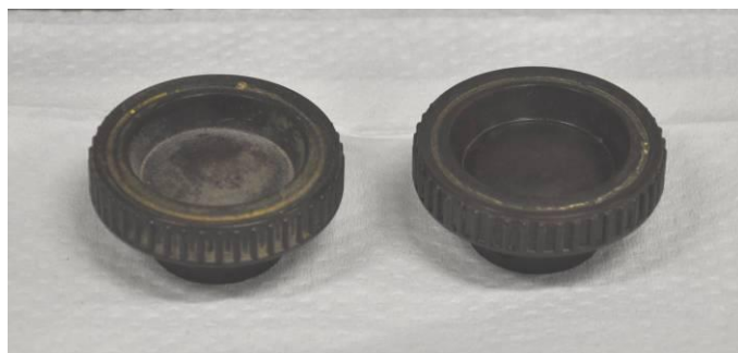
Kuva 35. Vasemmalla puhdistamaton säädinosa, oikealla saippuavedellä puhdistettu taajuussäädin.
