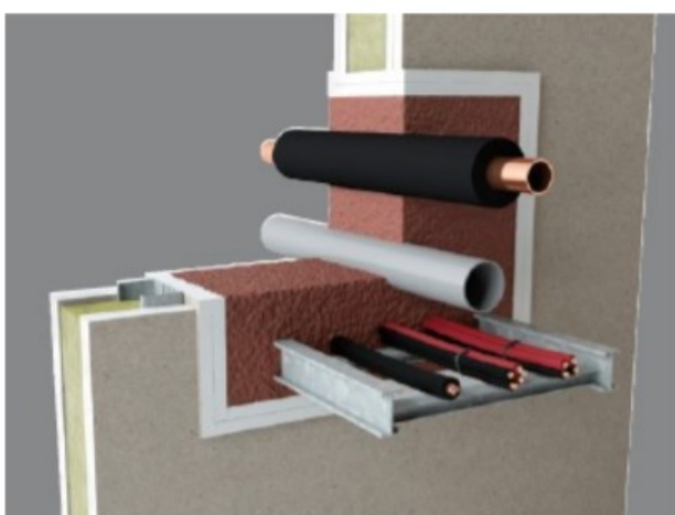
Kuva 7. 2-komponenttinen palokatkoavahto yhdistelmäläpiviennissä (Palokatko-opas 2019, 21).
