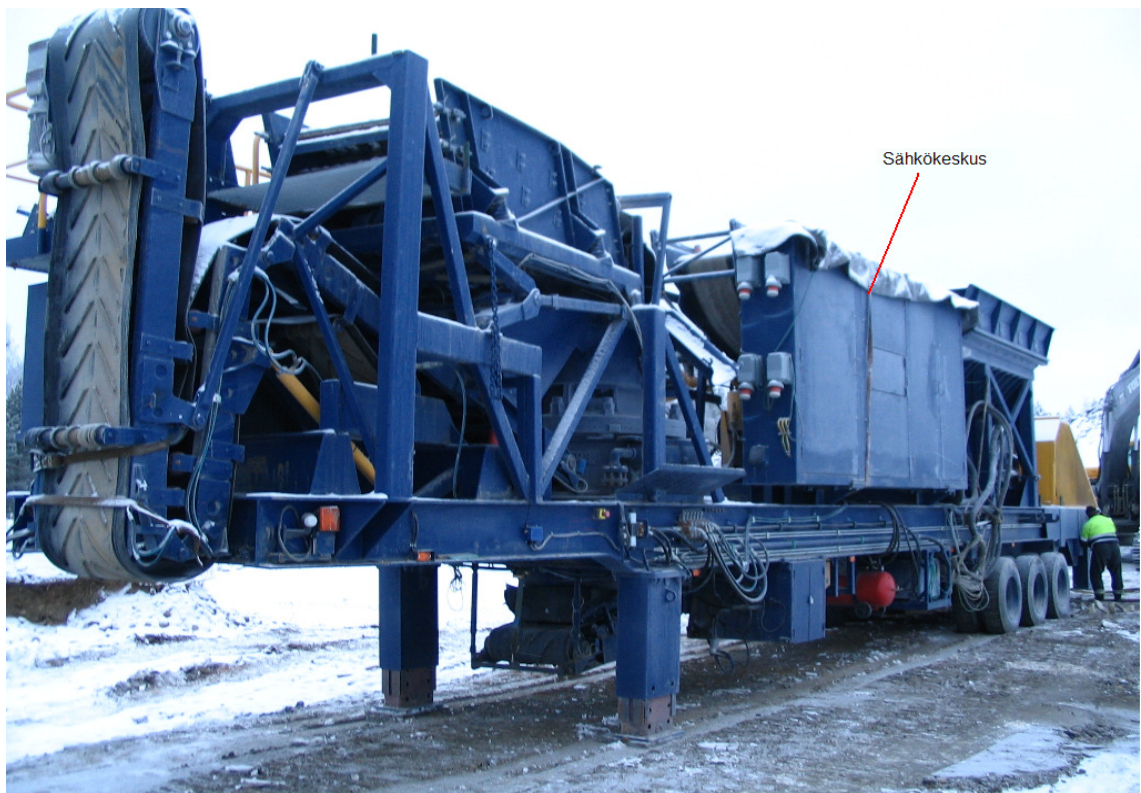
Kuva 1. Siirtokuntoon kasattu moreeninmurskausvaunu, johon automaatio on toteutettu.
