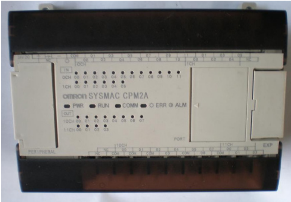
Kuva 5. Automaation sydän eli ohjelmoitava logiikka
