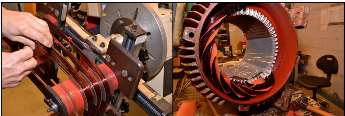
Kuva 7. Vyyhtien valmistus ja asennus
