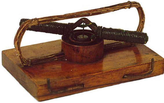
Kuva 1. Jedlikin moottori vuodelta 1823
