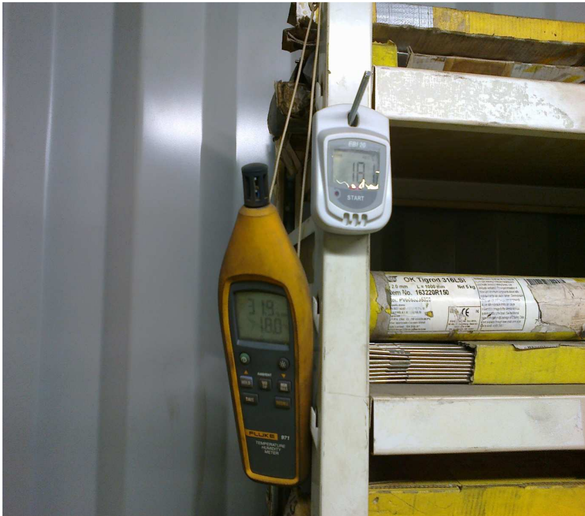
Kuva 11. Vanha kalibroitu Fluken kosteus-lämpötilamittari ja rinnalla uusi datalogger. Näytön mittausarvoja voi verrata toisiinsa oikeellisuuden varmistamiseksi.
