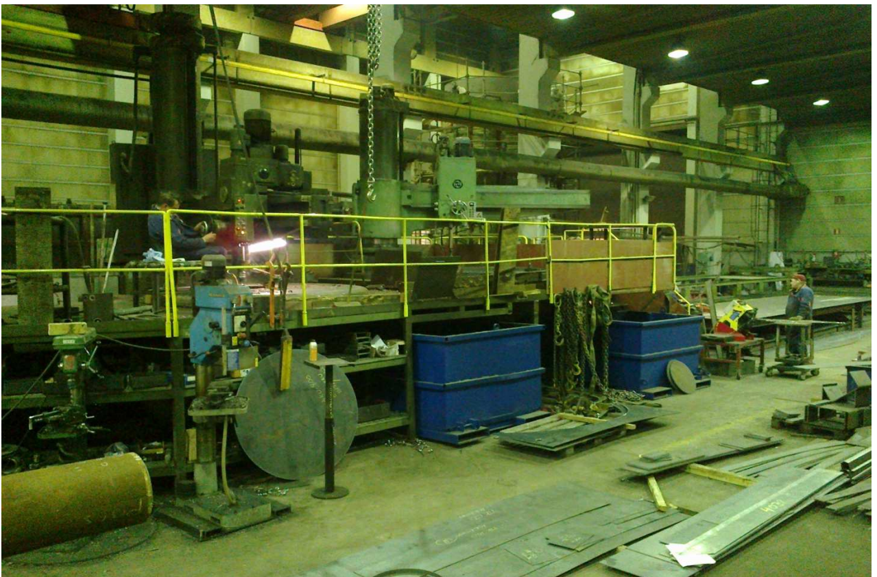
Kuva 7. Nyt kun porakoneet ovat vierekkäin ja poltteleikkauspisteen vieressä, siirtomatkat ovat lyhyet ja suuria päätyjä voi tarvittaessa porata kahdellakin koneella yhtä aikaa läpimenon nopeuttamiseksi.
