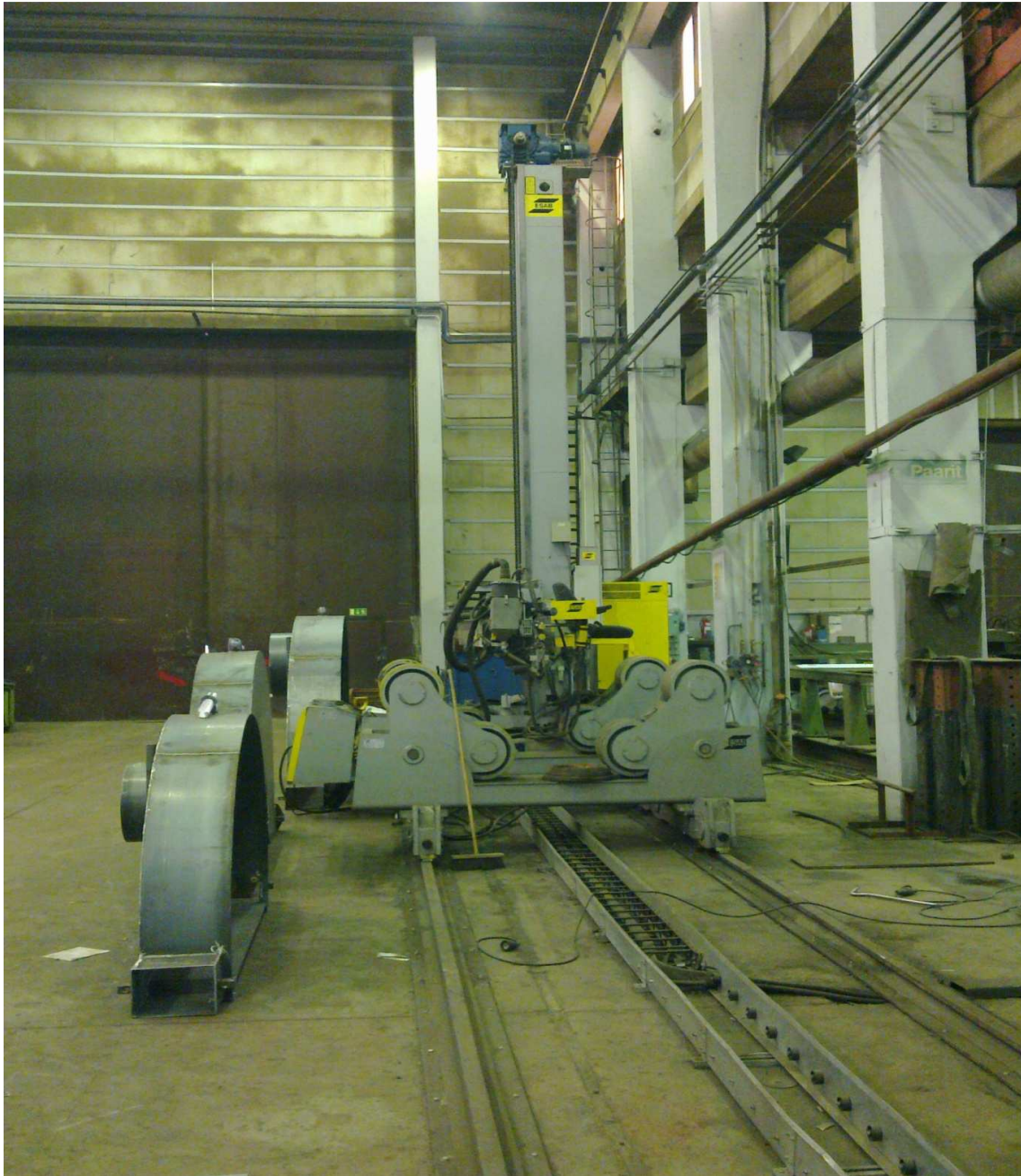
Nyt jauhekaaritorni tukkii oven edestä ison kattilakonstruktion lastaamisen ja ulos ajon. Tornin kiskot haittaavat merkittävästi ison kattilan kokoonpanotyötä
