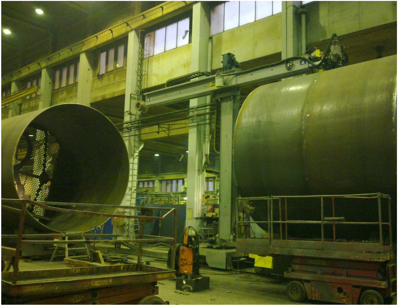
Kuva 8. Uusi jauhekaari käytössä. Työskentelykorkeus n. 5 metriä.
