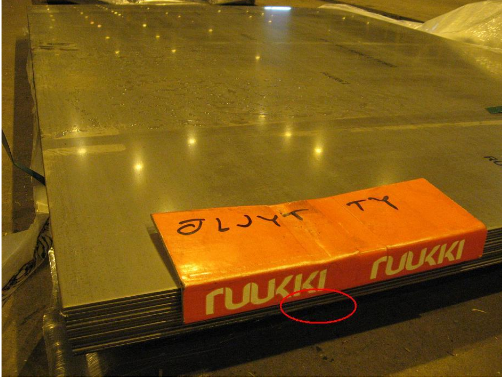
KUVA 15. Öljytty nippu. Alimmaisella levyllä korroosiota.
