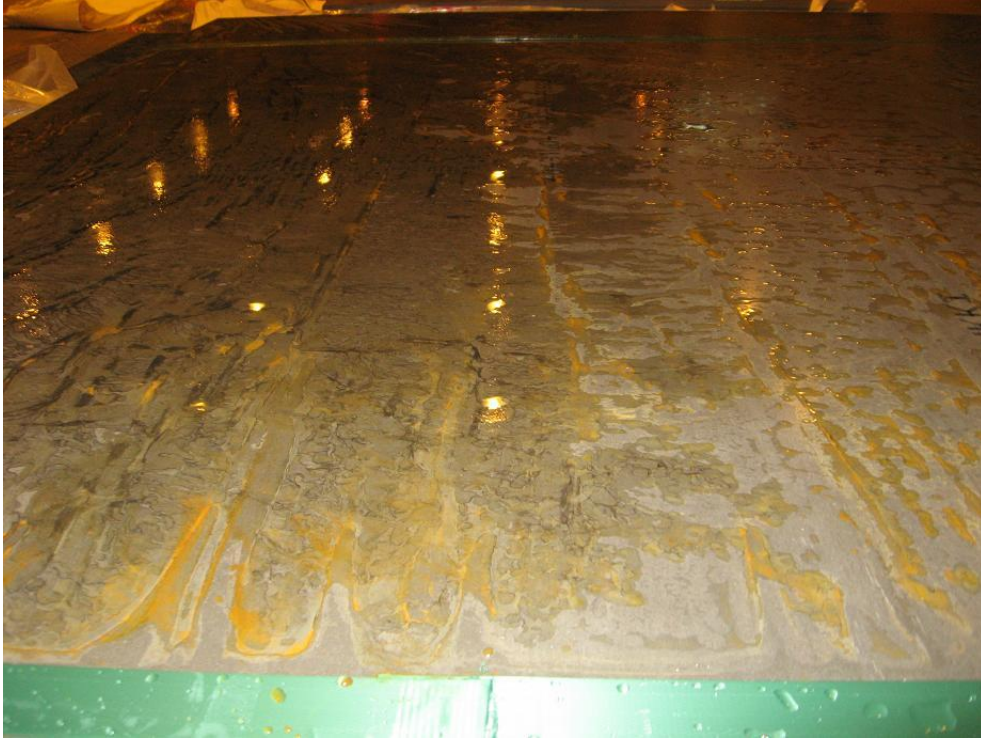
KUVA 16. VCI-ruiskutettu, suljettu nippu. Kastunut.
