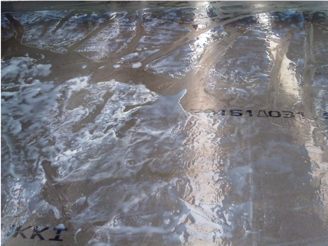
KUVA 9. VCI-ainetta on ruiskutettu liikaa.
