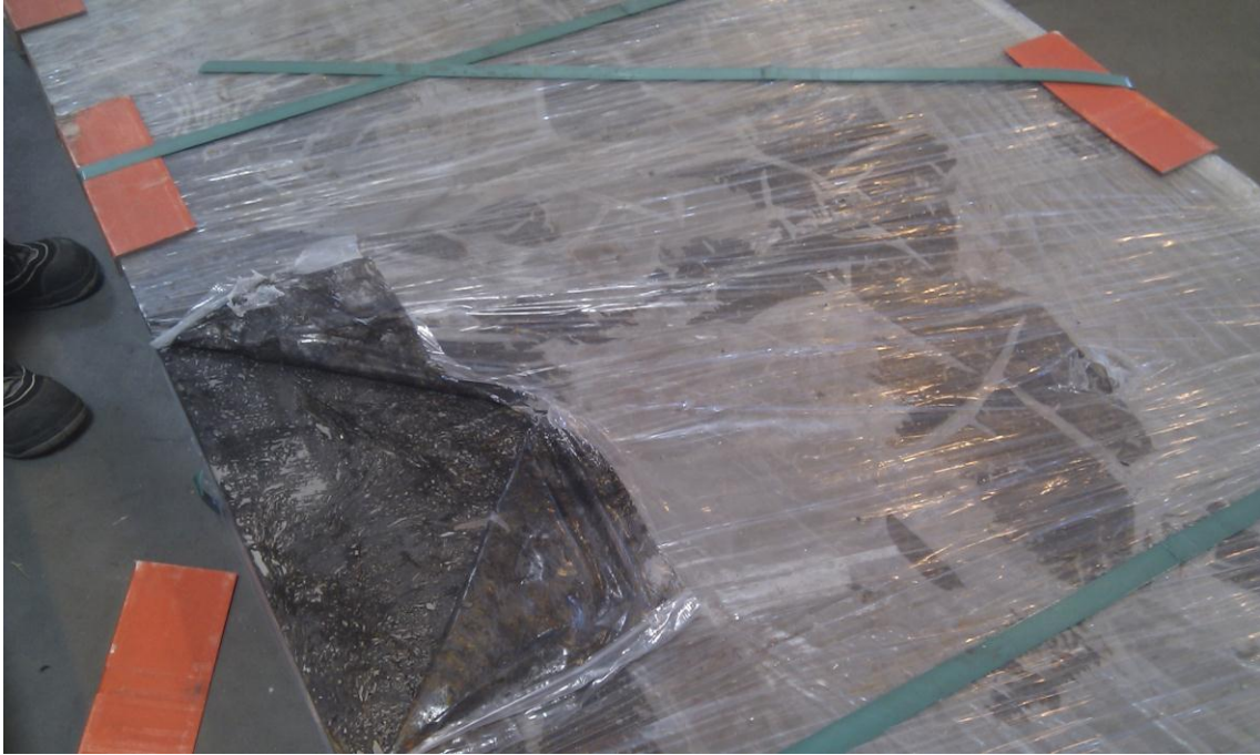
KUVA 4. Asiakkaan ottama kuva. Öljytyt levyt ovat päässeet kastumaan pakkauksessa.
