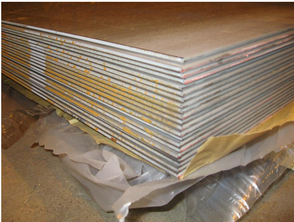
KUVA 20. VCI-paperiin pakattu, avoin nippu.
