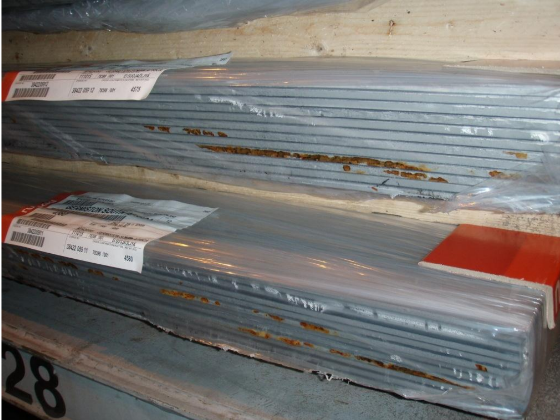
KUVA 10. VCI-suojattuja levyjä. Pakkauksessa reikiä.
