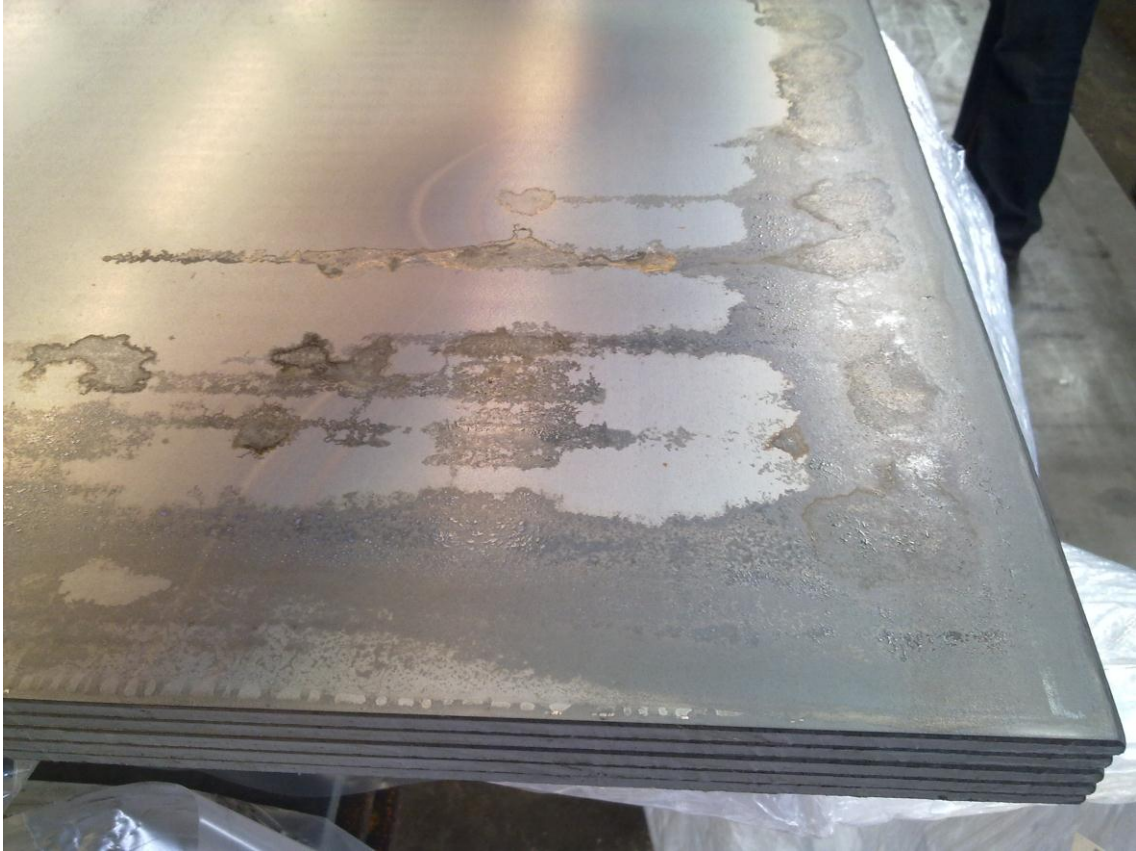
KUVA 3. Avattu VCI-ruiskutuksella suojattu teräslevypakkaus. Asiakas on lähettänyt pakkauksen takaisin. Pakkaukseen on selvästi jäänyt kosteutta ja ruostuminen on alkanut.
