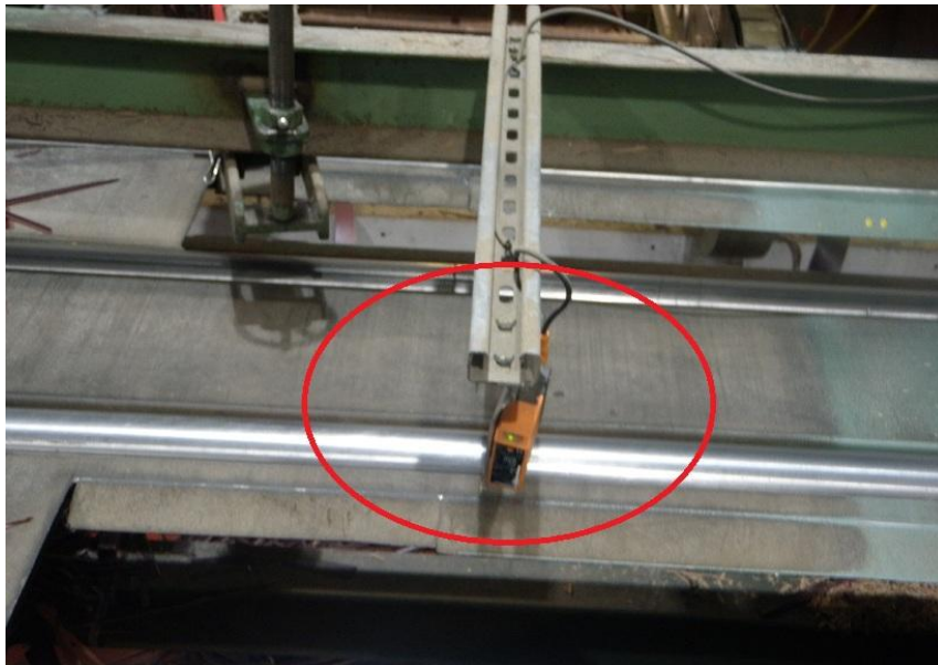
Kuvio 13. Vanerilevyn tunnistava optinen kytkin, jonka kytkintieto antaa keskittäjälle toimintasignaalin
