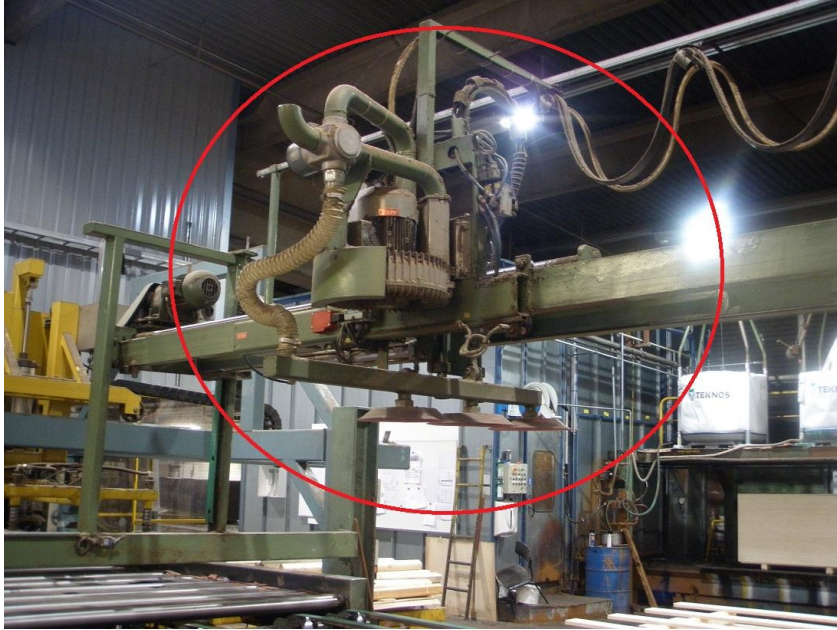
Kuvio 14. Imukuppinostin, jolla levyjen syöttö tapahtuu pinkasta ajettaessa
