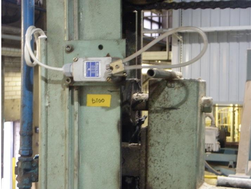
Kuvio 11. Jousikuormitteinen vipurajakytkin, joka ilmaisee syöttölaitteen olevan ylärajallaan
