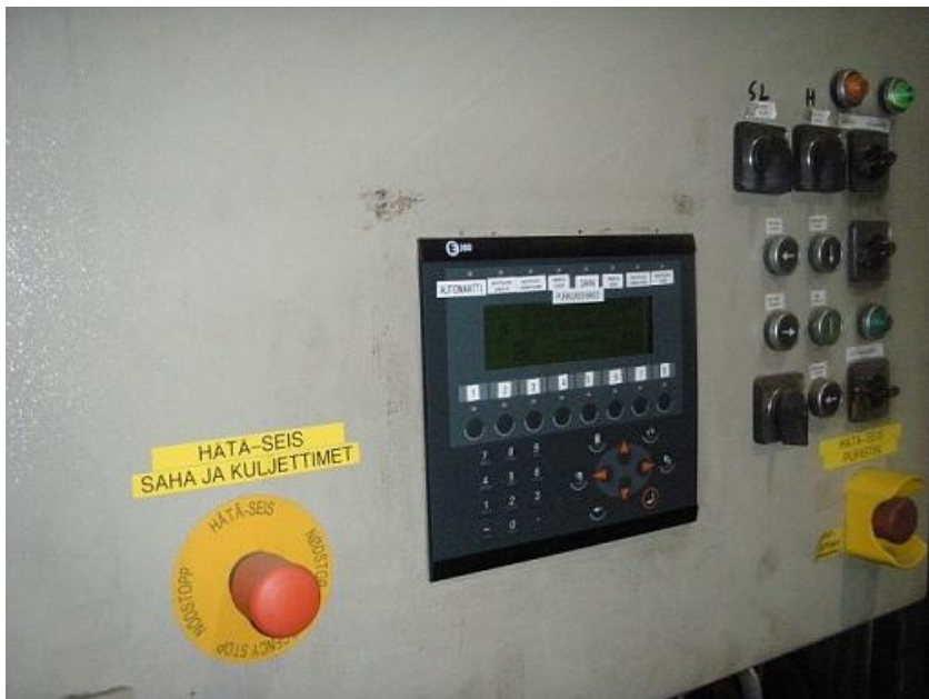
Kuvio 15. Syöttölaitteen ohjauskytkimet, joilla linjan toimintoja voidaan ohjata käsin
