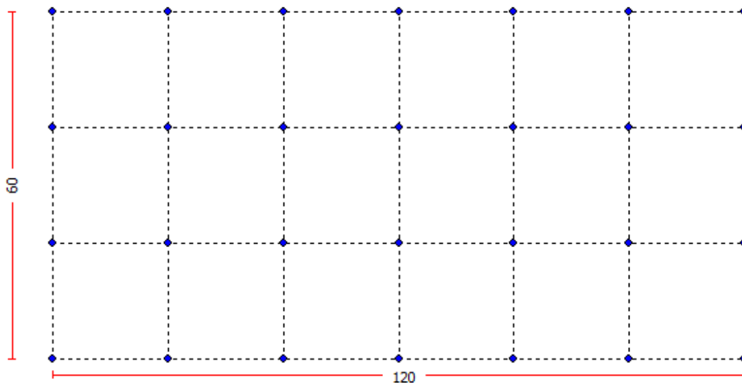
Kuva 39. Lämpökaivokenttä 4 x 7, 28 kpl lämpökaivoja.
