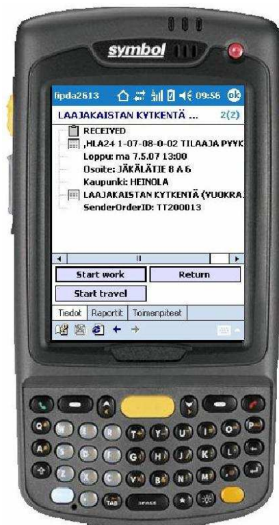
Kuva 2 Eltel Networks:in teleliiketoiminnassa käytössä oleva PDA-laite, eli kämmentietokone
