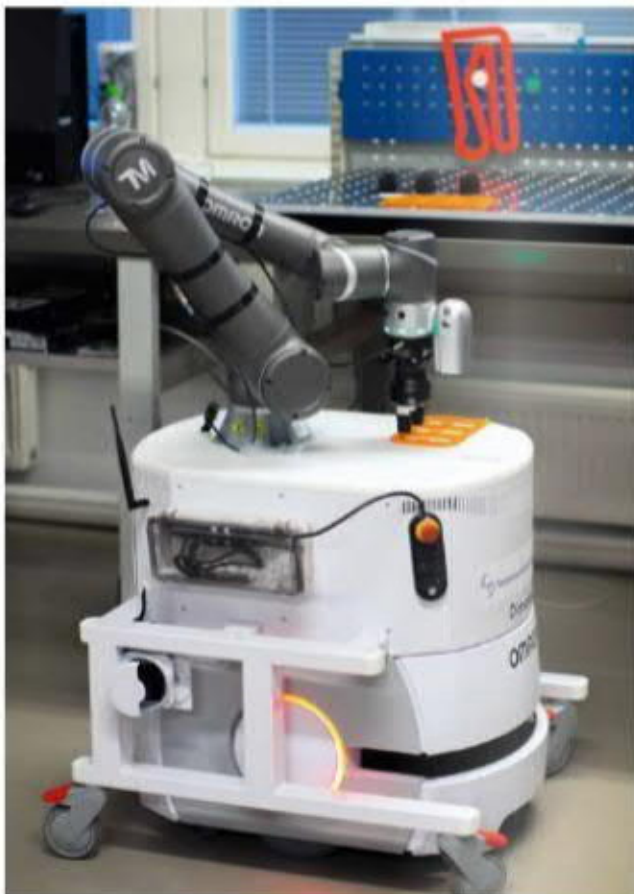
Kuva 1 Robottikäsi asennettuna Omron-mobiilirobotillaustalla.
