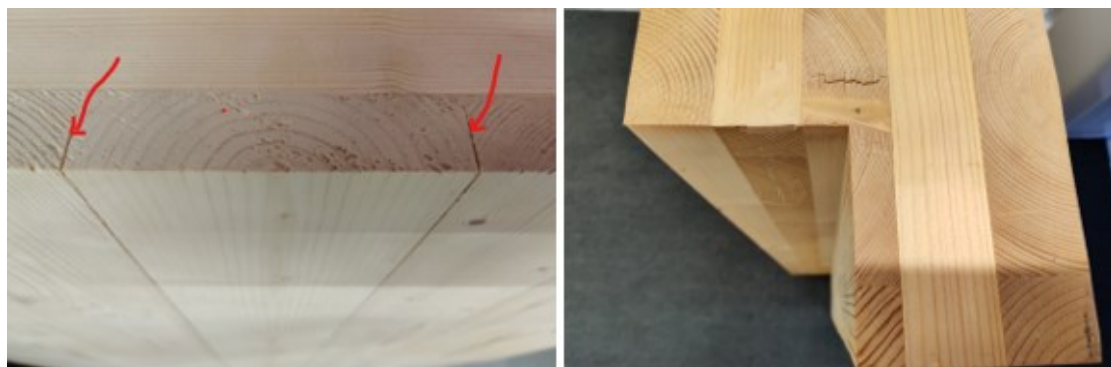
Kuva 11. Kyseisen haastattelun kuva 1 vasemmalla puolella. Syrjäliimaamattoman CLT-levyn liitokset pintalamellissa, oikealla puolella syrjäliimattu CLT-levy liitoksissa (Peltokangas, J. sähköpostikysely 2020.)
