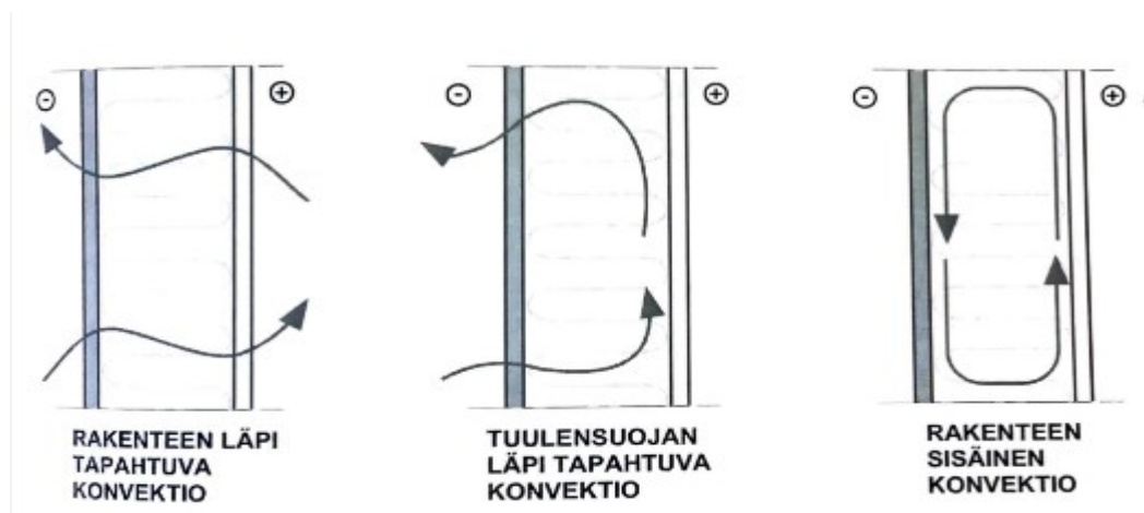
Kuva 1. Konvektiotapaukset seinärakenteissa (Vinha 2011, 69)
