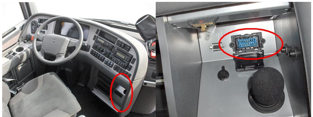
Kuvat 5 ja 6. OBD-pistokkeen sijainti Volvon 9700-sarjan linja-autossa
