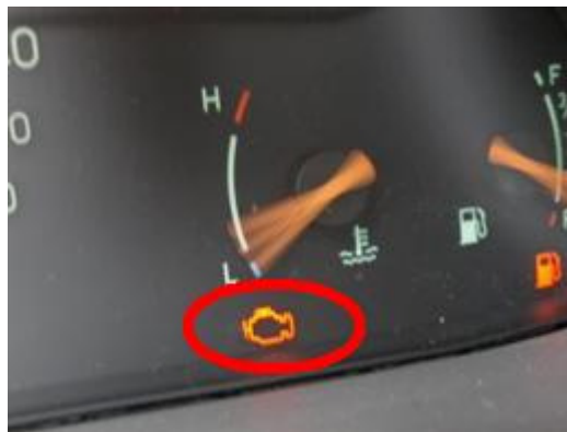
Kuva 2. OBD-merkkivalo Saab 9-5 -henkilöautossa
