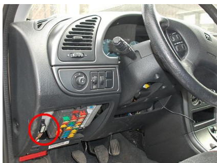
Kuva 1. OBD-pistoke Citroen Xsara HDI -henkilöautossa
