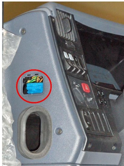
Kuva 4. OBD-pistokkeen sijainti Scanian P-, R-, T- ja G-sarjojen kuorma-autoissa
