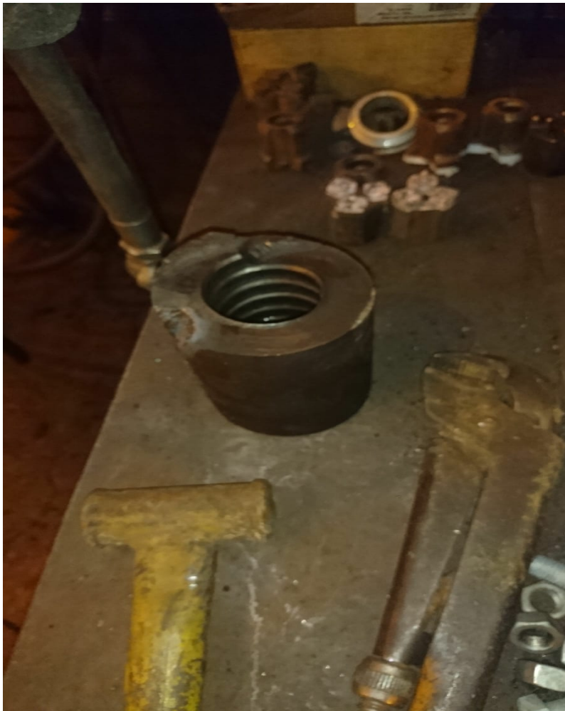
Kuva 7. Haljennut poran istukka
