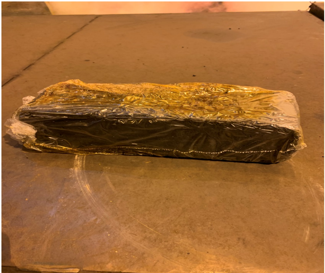
Kuva 4. Ma1 käytössä oleva sulkumassa TRB Ecotap 243M
