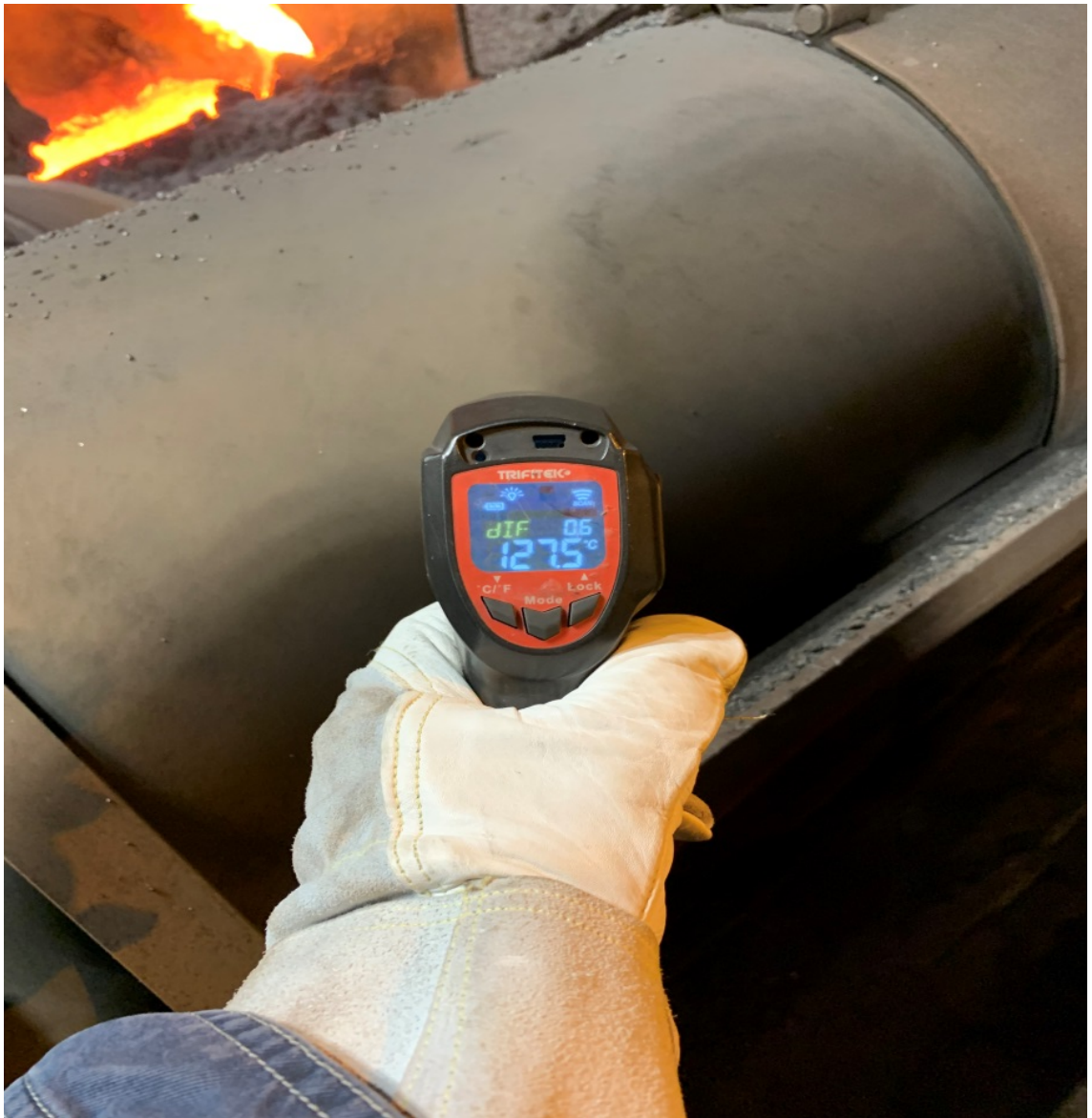
Kuva 10. Sulikutykin täyttösylinterin lämpötila sulun jälkeen 127.5° C
