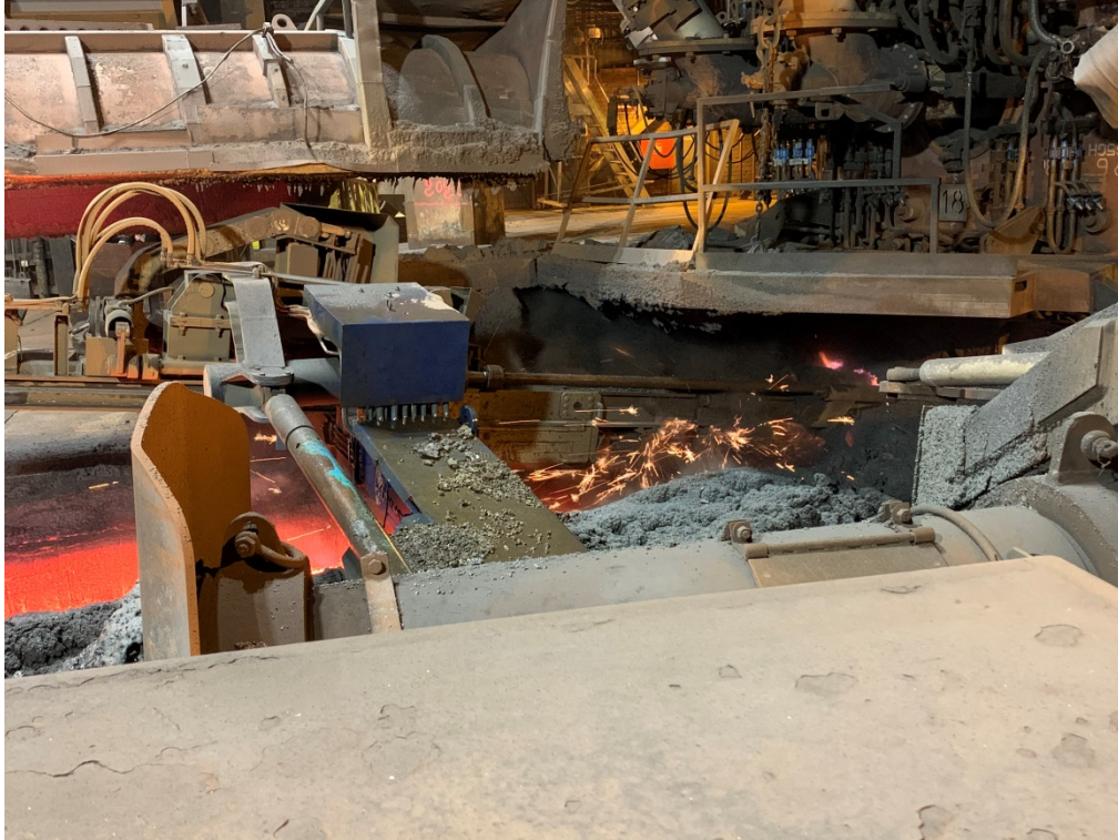
Kuva 6. Rautareiän poraus masuunin aukaisuporalla Ma2:lla
