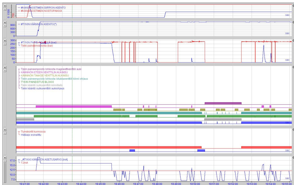
Kuvio 36. Sulkutykki juuttunut rautareialle sulun jälkeen
