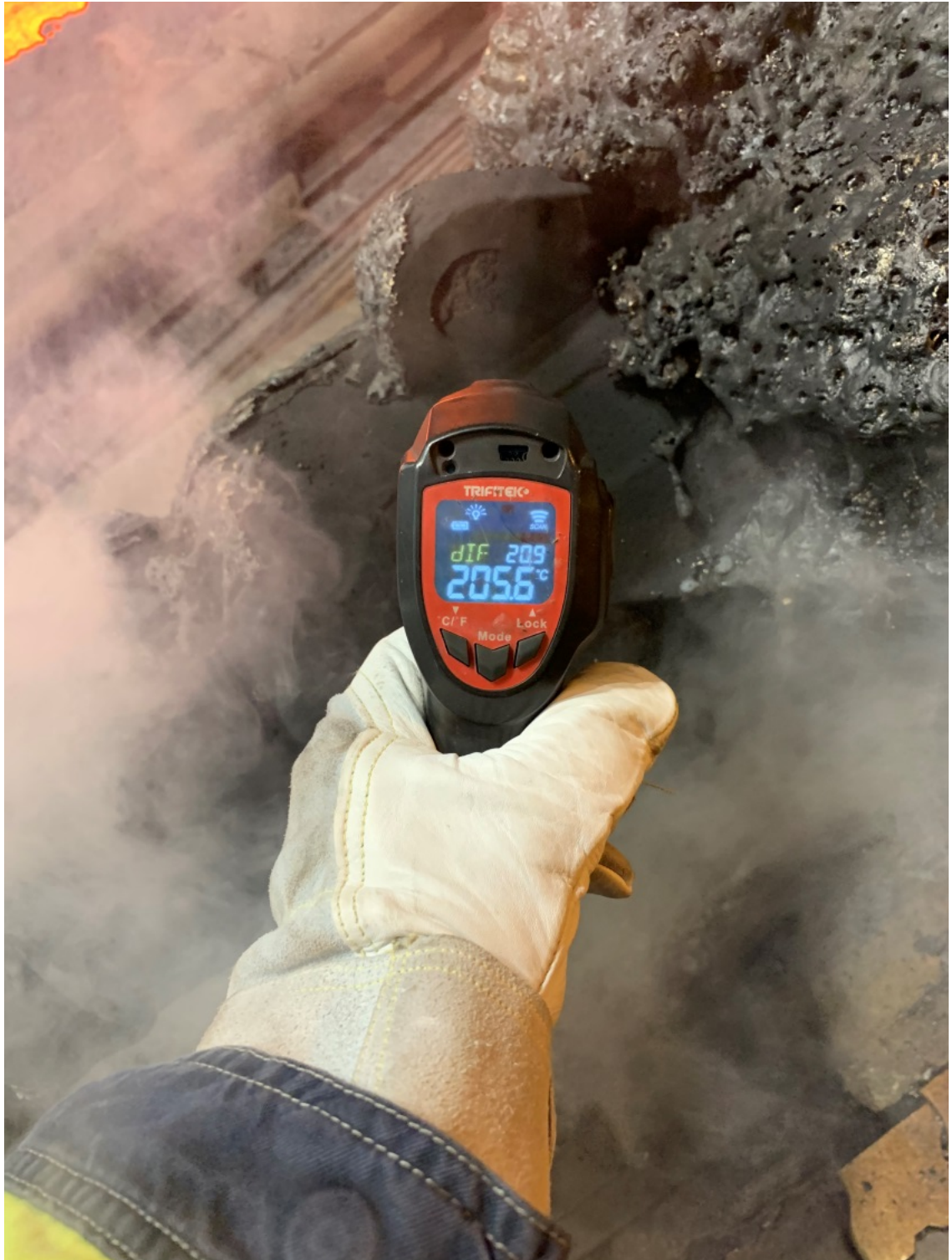
Kuva 9. Sulkutykin kartion lämpötila sulun jälkeen 205.6° C
