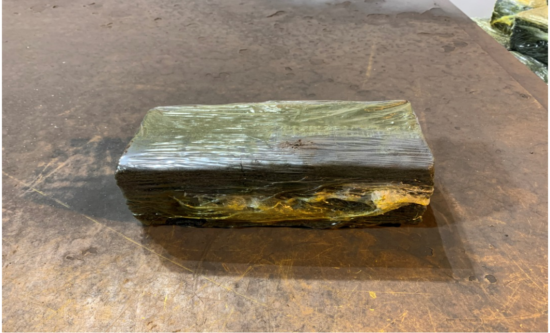
Kuva 5. Ma2:lla käytössä oleva sulkumassa Lungmuß HT 20/2 R V3
