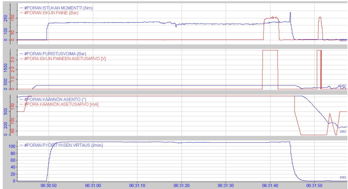
Kuvio 24. Aukaisuporan istukka haljennut avauksessa 29.09.20 klo 06.31
