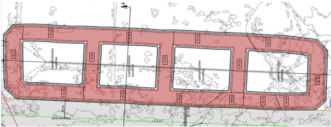
Kuva 10. Suojavalli 2 Kaivuusuunnitelma korkoon +87.00 (GeoPro Consulting, 2020.)
