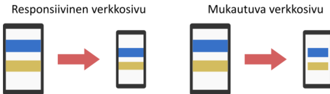
KUVIO 4. Miten responsiivisen ja mukautuvan verkkosivun ulkoasut reagoivat päätelaitteen näytön koon mukaan
