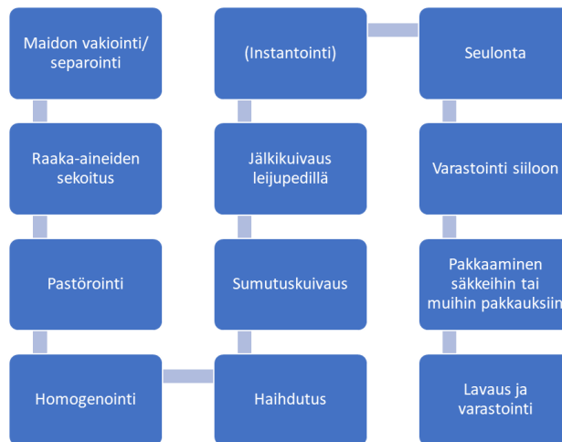
Kuva 1. Maitopohjaisen jauheen valmistuksen prosessikaavio. (Tapaila, 2010, s. 61; Schuck ym., 2013, s. 476; ks. myös Guo ym., 1998, s. 333).
