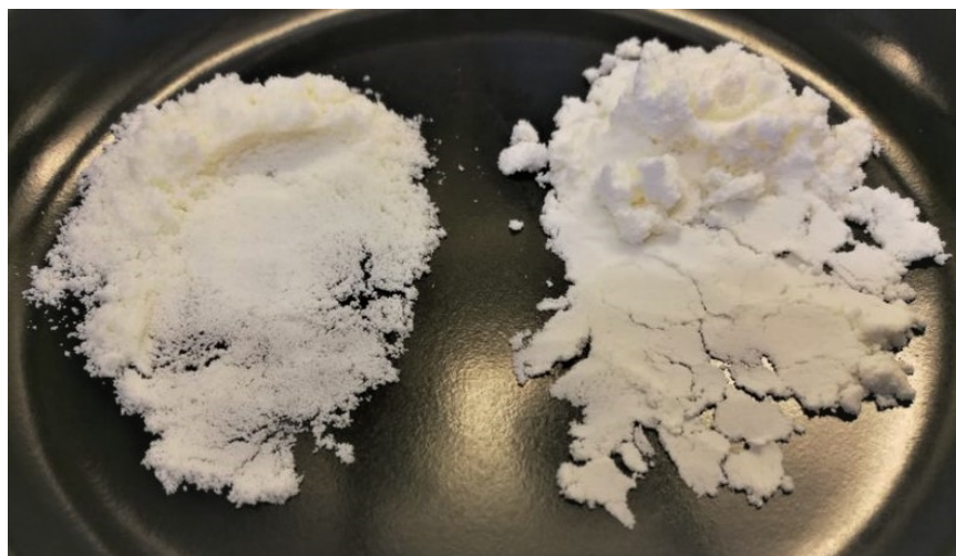
Kuva 5. Kuva kapealla ja leveällä sumulla valmistetuista jauheista neljännellä koeajoviikolla, kun testattiin uudestaan prosessiparametrien vaikutusta jauheeseen. Kuvassa vasemmalla on kapealla sumulla valmistettua jauhetta ja oikealla puolella leveällä sumulla
