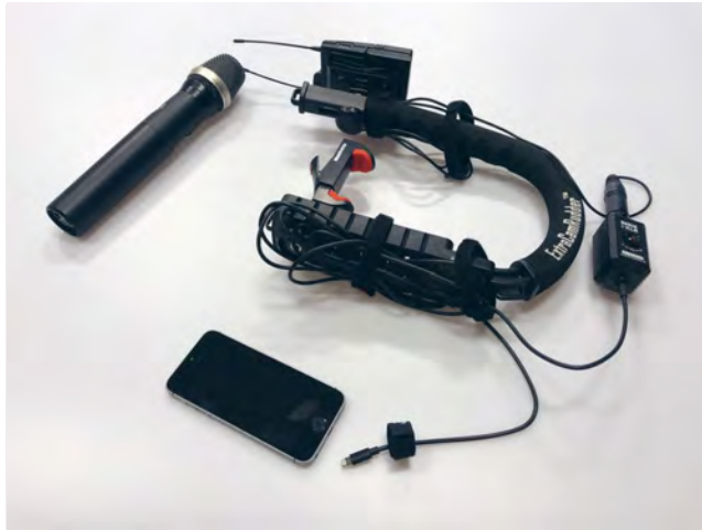
Kuva 2. Vuorovaikutteiseen live-vierailu navetassa testattu Zoom-lähetysyksikkö
