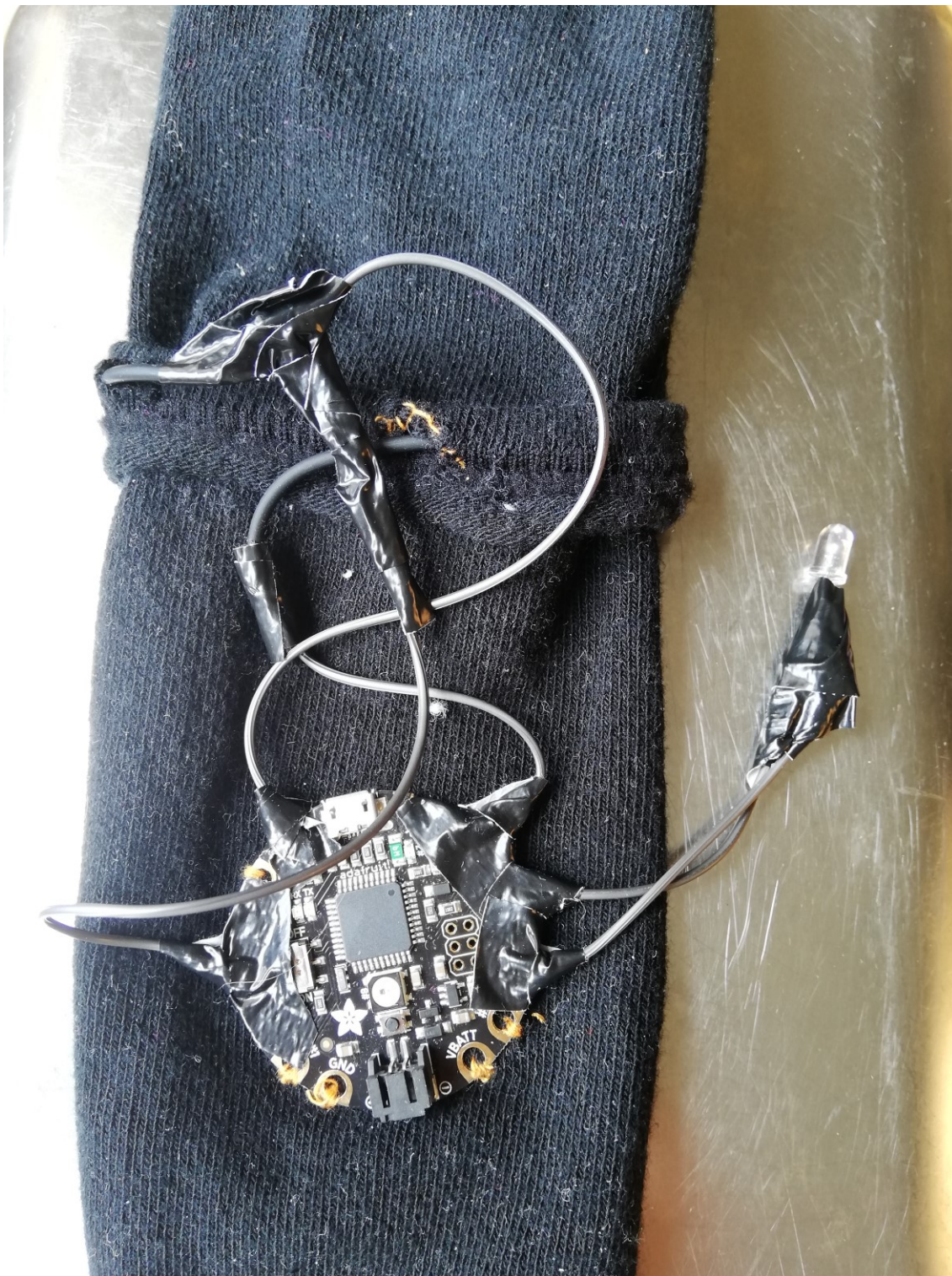
KUVA 10. Arduino Flora sekä venyvyyss anturi kiinnitetty sukkaan.
