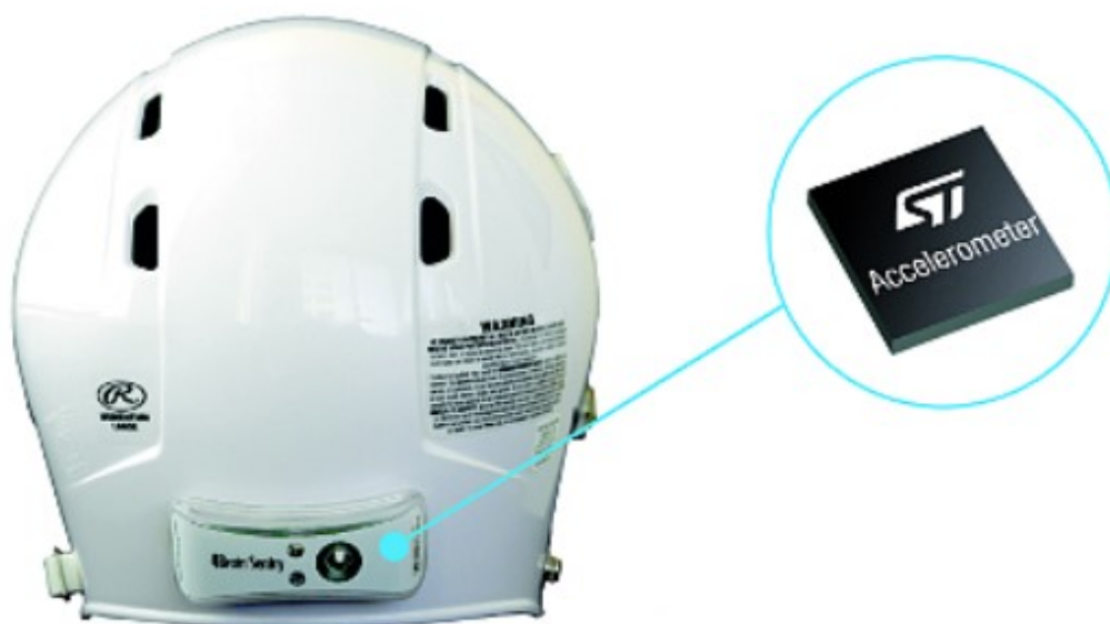
KUVA 1. Anturin sijoittuminen kypärässä (Anturi monitoroi aivotärähdyksiä. Elektroniikkalehti).
