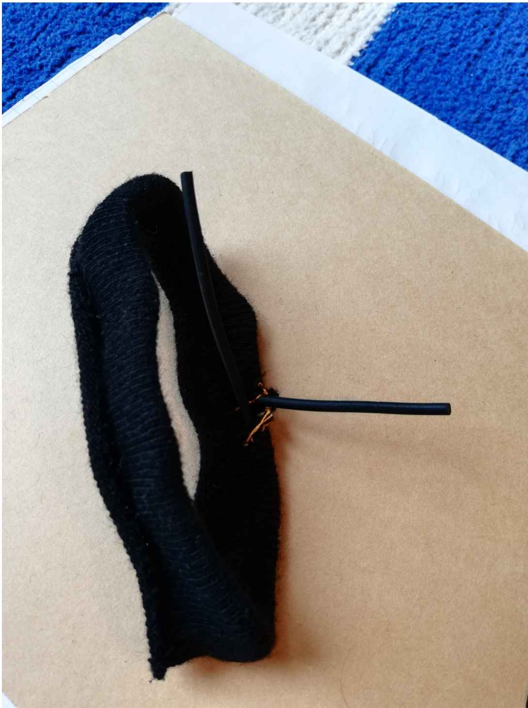
KUVA 9. Venyvyysanturi asetettu kangaskujan sisälle.
