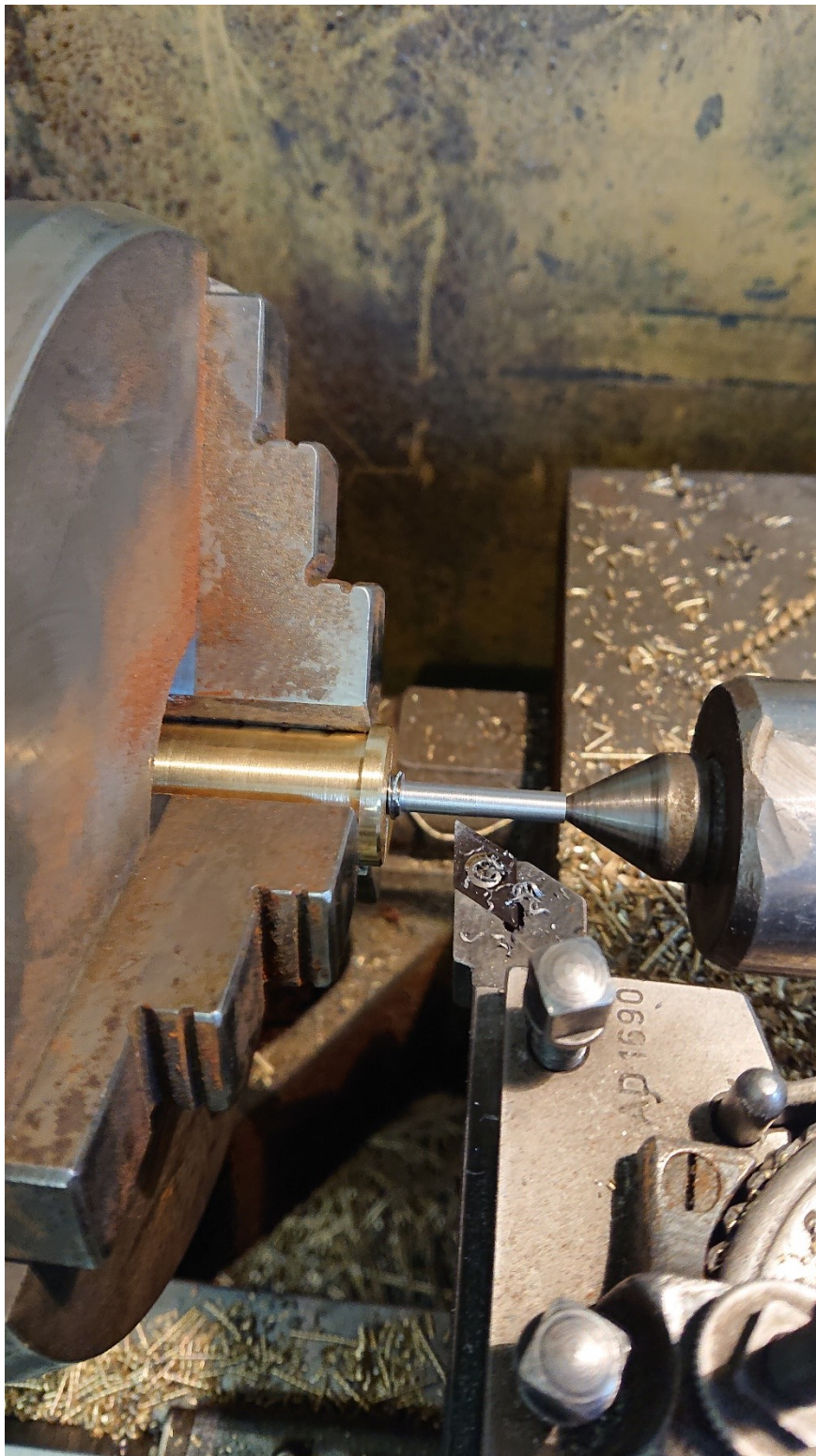
Kuva 40. Kuularuuvien päädyn koneistus menossa.
