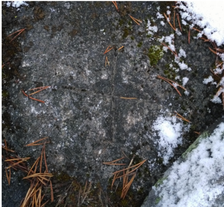
Kuva 20. Tornioista pohjoiseen Struven ketjun pisteet tunnistaa maastossa ristin muotoisista kai-verruksista (Kuva: Maanmittauslaitos) [35].
