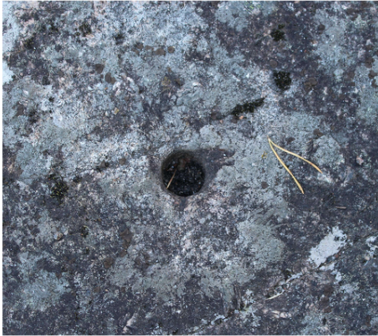
Kuva 19. Etelä-Suomesta Tornioon Struven ketjun pisteet tunnistaa poranreikästä kalliossa (Kuva: Maanmittauslaitos) [35].
