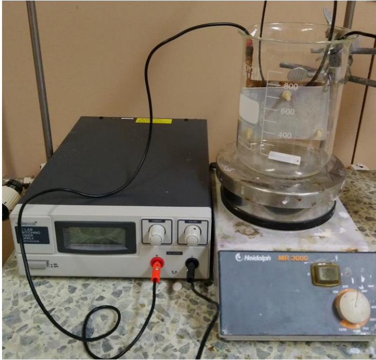
Kuva 2. Laboratoriossa käytetty pienen mittakaavan panostoiminen EC-laitteisto.
