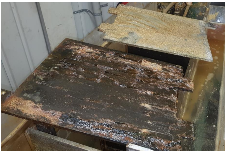
Kuva 8. Rauta- ja alumiinianodit koeajon jälkeen.
