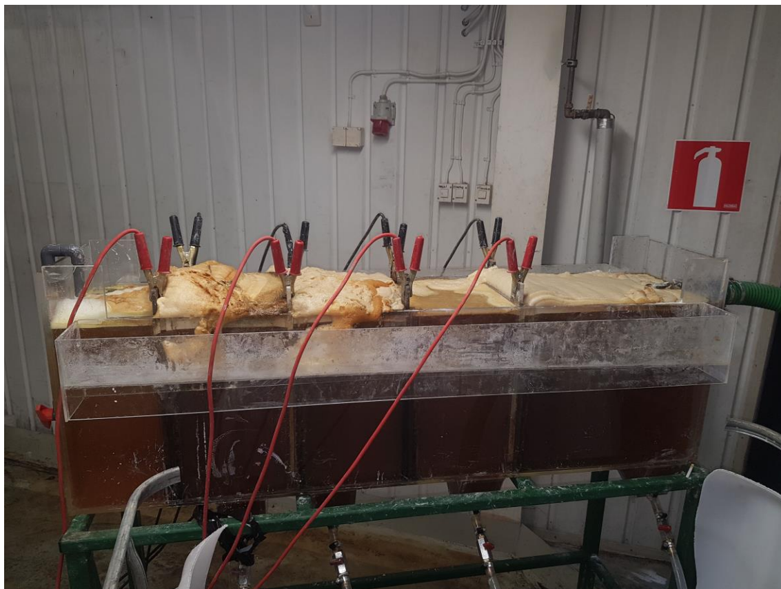
Kuva 7. Ajon aikana muodostuva vahtokerros pilottilaitteessa.
