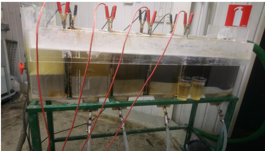
Kuva 5. Yön yli laskeutunut kiintoainefaasi pilottilaitteistossa.
