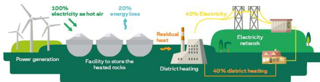
KUVA 1. Kivilämpövaraston toimintaperiaate (SEAS-NVE n.d.)
