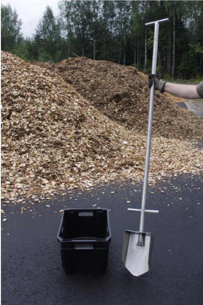
KUVA 3. Manuaalisessa näytteenotossa käytettävä pitkävartinen kauha, jonka suuaukon läpimitan on oltava vähintään 2,5 kertaa nimellisesti suurin palakoko (5, s. 32)
