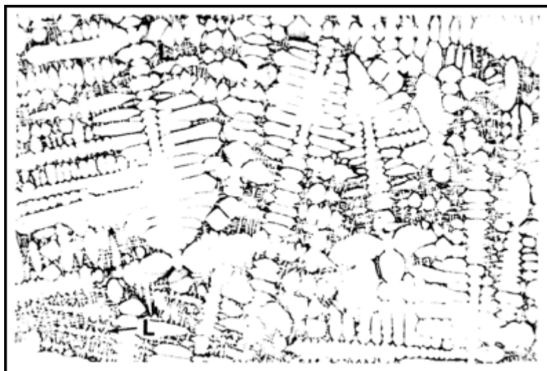
Figur 16. Exempel på dentriter i ett mikroprov. (Jernkontoret, (2004), s. 24)
