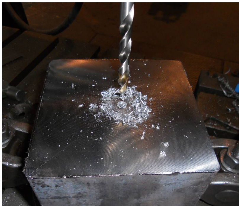
Figur 21. Bild på ett borrhållprov och spån från ett 5 mm djup.
