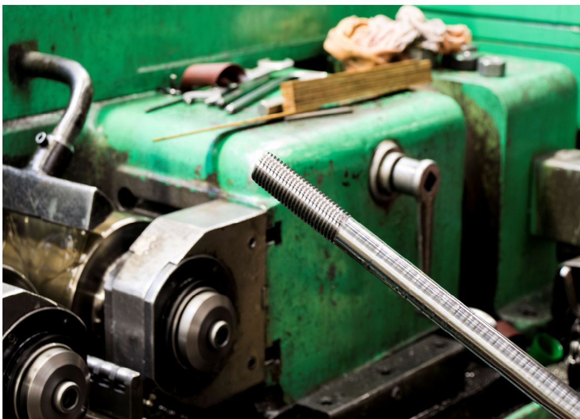
Figur 24. Bild på utförd rullgängning av rundstång. (Pretec, 2020)
