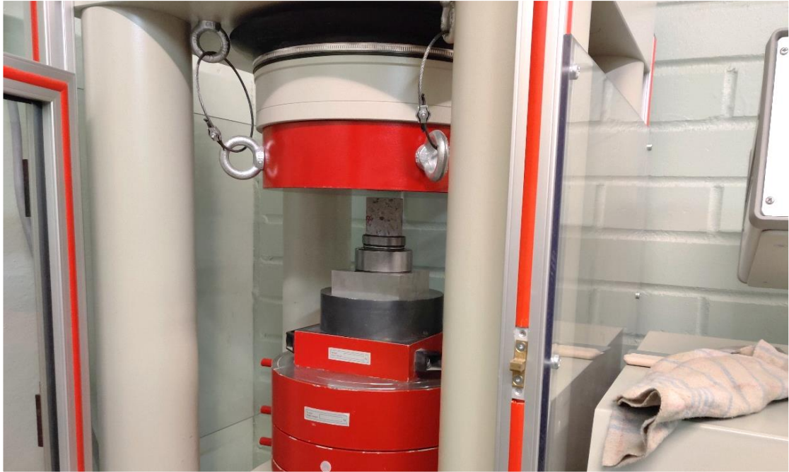
Kuva 19. Näytekappale asetettuna Form + Test Alpha 3-3000 AR –laitteeseen ja valmiina puristuskokeeseen.
