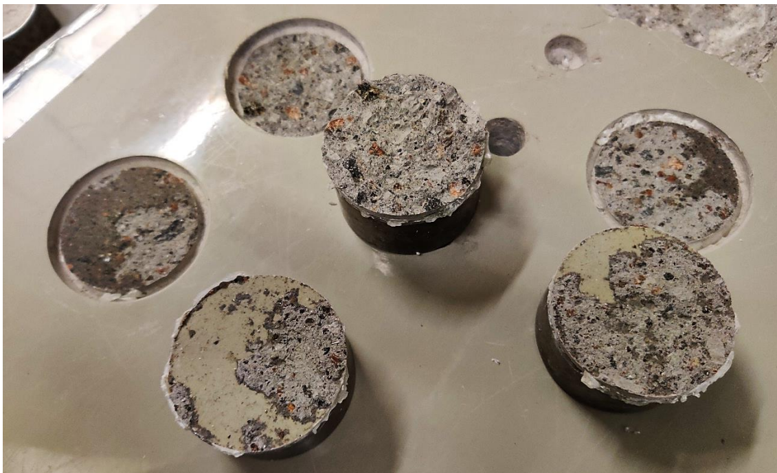
Kuva 2. Ennakkovaiheen P2 tartuntavetolujuuskokeiden (294 N/s) vetonapit ja murtoalueet vasemmalta oikealle: veto 1 (murto 25% A, 75% B/C), veto 2 (murto 100% A) ja veto 3 (murto 90% A, 10% B/C).
