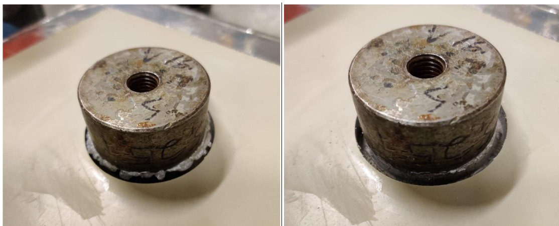
Kuva 16. Vetoalueen reunan yli pursunneet liimat (näkyvissä kuvassa vasemmalla) poistetaan puukolla.
