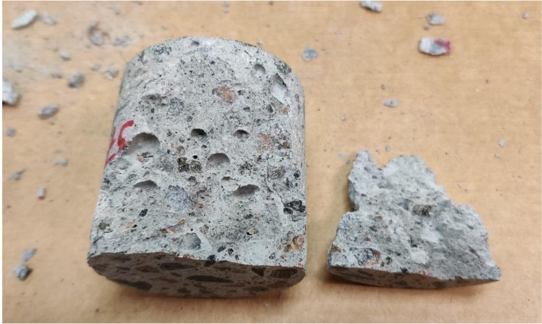
Kuva 36. Kuvassa on esitetty pinnoiteyhdistelmän P2 näytekappale (1E) puristuskokeen jälkeen. Murtuneesta betonista nähdään rakenteen sisään jääneitä tiivistyshuokosia.
