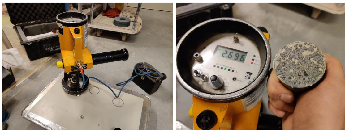
Kuva 17. Vasemmalla vetolaite F-20 D Easy M on kiinnitetty vetonappiin ja valmiina suoritettavaan vetokokeeseen. Oikealla nähdään laitteen mittaama vetolujuus (2,696 N/mm 2 ) ja murtokohta tarkastelussa.
