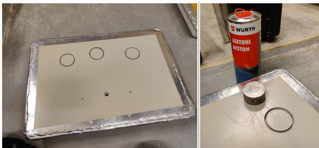
Kuva 14. Vasemmalla laatan vetoalueet on rajattu 50 mm halkaisijan timanttikruunulla ja oikealla on esitetty puhdistettava vetoalue ja -nappi sekä puhdistukseen käytetty aseton.
