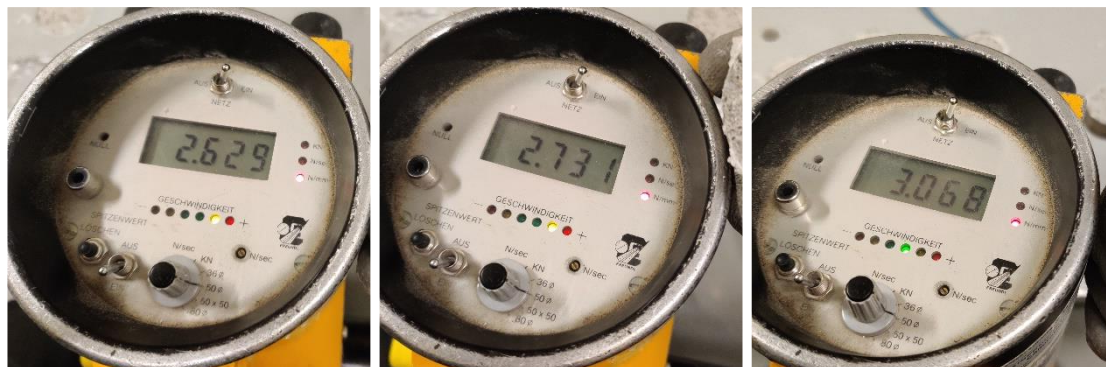
Kuva 3. P2 ennakkovaiheen tartuntavetolujuustulokset (vetonopeudella 294 N/s) järjestyksessä vasemmalta oikealle: veto 1 (2,629 N/mm 2 ), veto 2 (2,731 N/mm 2 ) ja veto 3 (3,068 N/mm 2 ).
