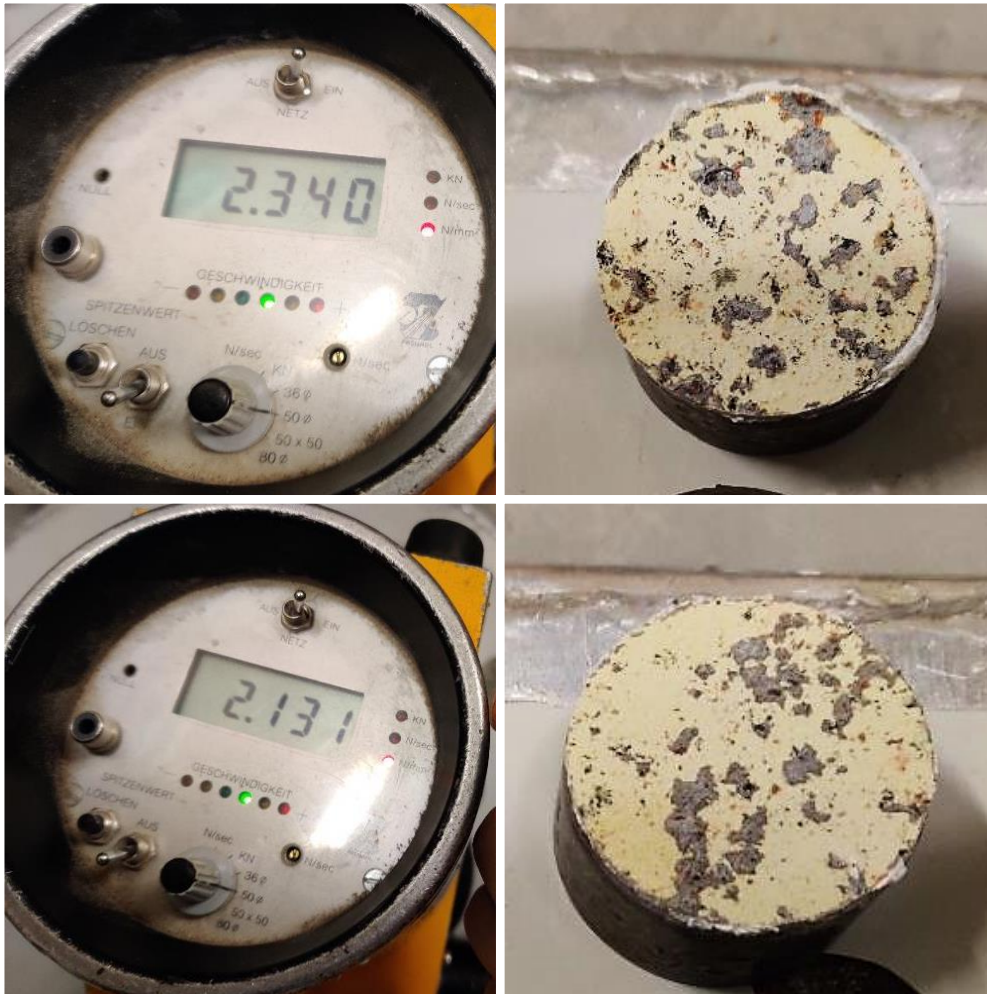
Kuva 15. Kuvasarja P7 lisätartuntavetolujuustuloksista ja murtokohdista.
