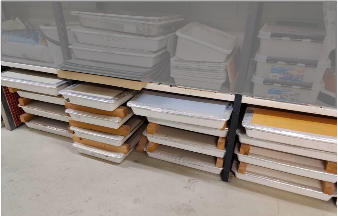
Kuva 8. Alkuperäisessä tutkimuksessa valettujen ja pinnoitettujen koekappaleiden säilytys on tapahtunut sisätiloissa (n. +20 °C) kymmenen vuoden ajan. Muovimuottien ja pinnoitteiden rajapinnat on tiivistetty alumiiniteipillä reunoilta tapahtuvan kuivumisen estämiseksi.
