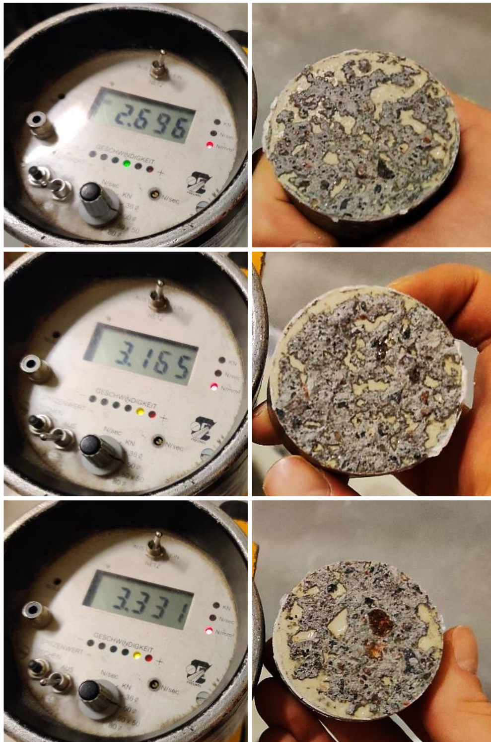
Kuva 5. Kuvasarja P3 tartuntavetolujuustuloksista ja murtokohdista.
