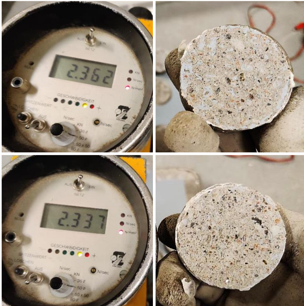
Kuva 19. Kuvasarja P8 lisätartuntavetolujuustuloksista ja murtokohdista.
