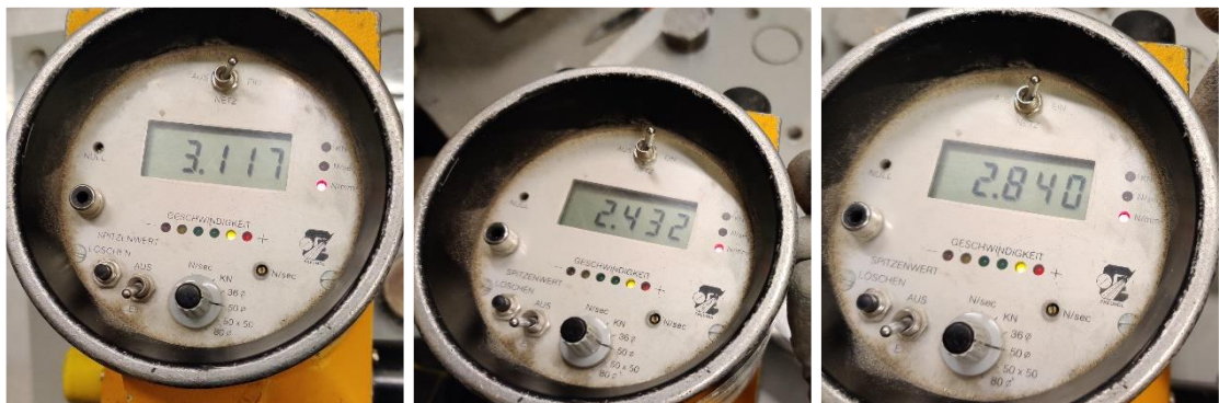
Kuva 5. P4 ennakkovaiheen tartuntavetolujuuskokeiden (vetonopeudella 98 N/s) järjestyksessä vasemmalta oikealle: veto 1 (3,117 N/mm 2 ), veto 2 (2,432 N/mm 2 ) ja veto 3 (2,840 N/mm 2 ).
