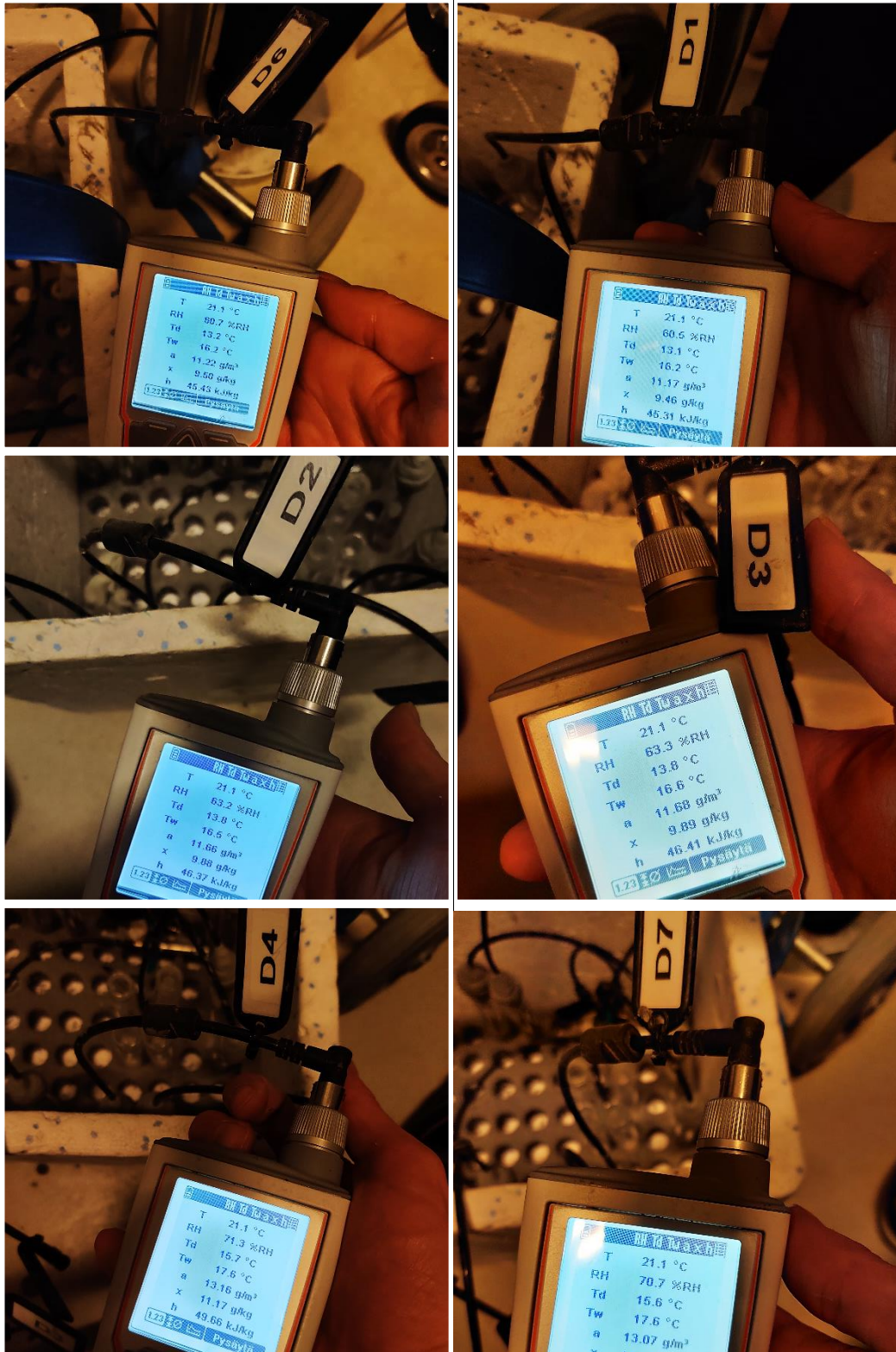
Kuva 4. Kuvasarja ennakkovaiheen P4 kosteusmittauksista pinnan kautta kerätyistä näytepa-loista.
