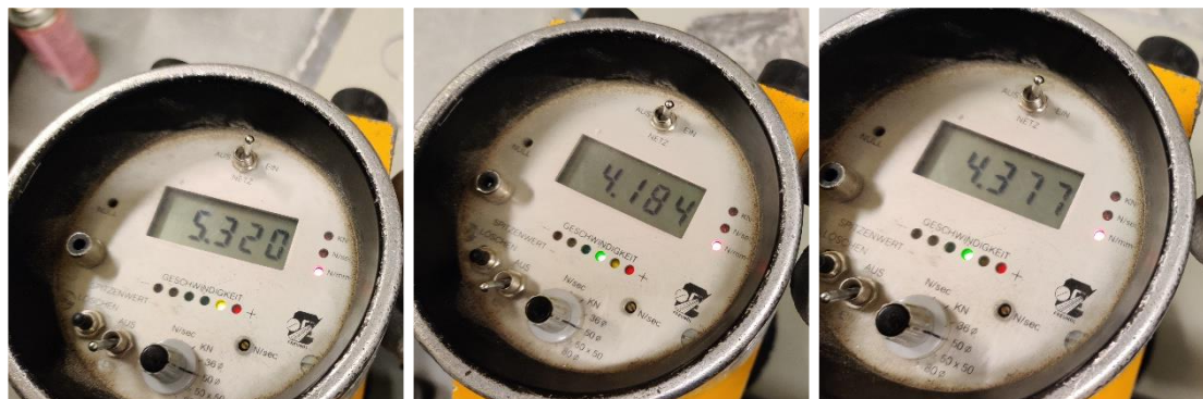
Kuva 1. P2 ennakkovaiheen tartuntavetolujuustulokset (vetonopeudella 294 N/s) järjestyksessä vasemmalta oikealle: veto 1 (5,320 N/mm 2 ), veto 2 (4,184 N/mm 2 ) ja veto 3 (4,377 N/mm 2 ).
