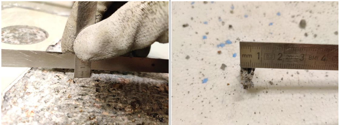
Kuva 11. Vasemmalla on esitetty näytekuopan syvyyden varmistus. Kyseisen koekappaleen pinnoitteen paksuus on n. 2 mm, joten seuraavat näytemuruset tulevat betonin syvyydeltä 5–10 mm. Oikealla kuvassa on yli 5 mm paksuinen betonimurunen, joita ei hyväksytä näytteenkeruussa.
