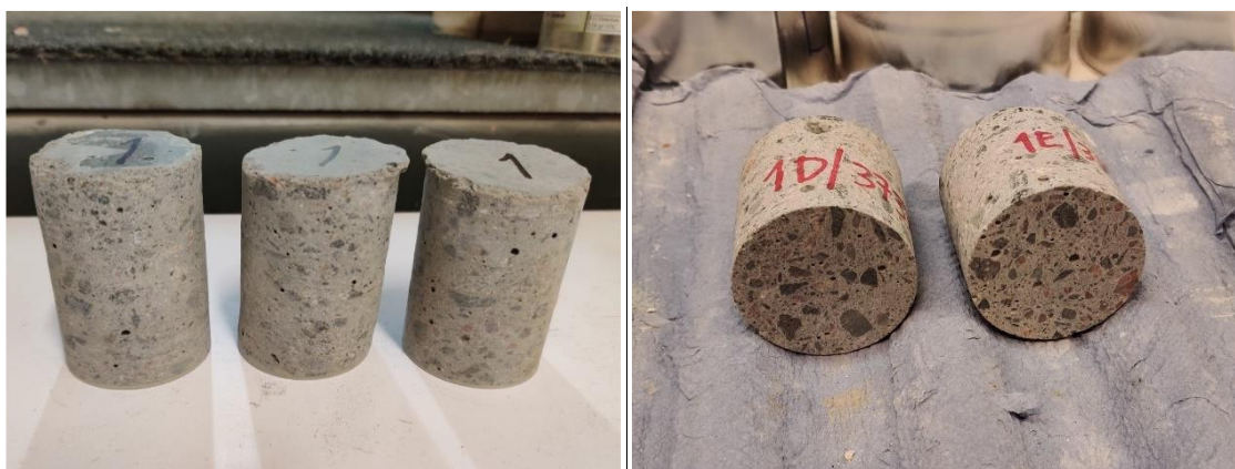
Kuva 18. Vasemmalla on esitetty koekappaleista timantilla poratut näytekappaleet ja oikealla näytekappaleet on sahattu ja hiottu 1:1 korkeuden ja halkaisijan suhteen.
