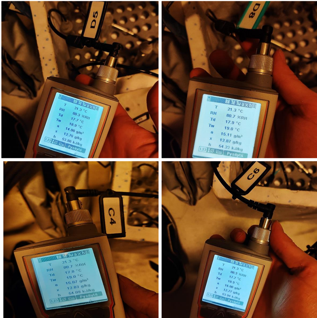
Kuva 2. Kuvasarja ennakkovaiheen P2 kosteusmittauksista pohjan kautta kerätyistä näytepa-loista.
