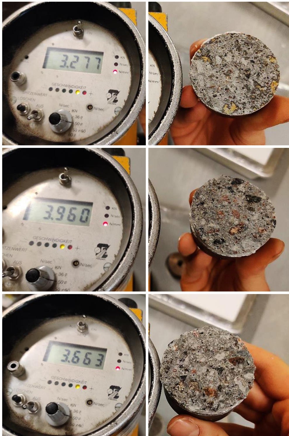
Kuva 1. Kuvasarja P1 tartuntavetolujuustuloksista ja murtokohdista.
