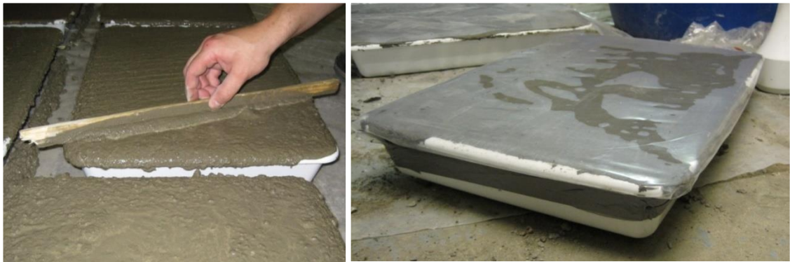
Kuva 6. Kuvassa vasemmalla on tilannekuva koekappaleiden linjauksesta ja oikealla jälkihoitomuovi on tiivistetty yksittäisen koekappaleen päälle [8].
