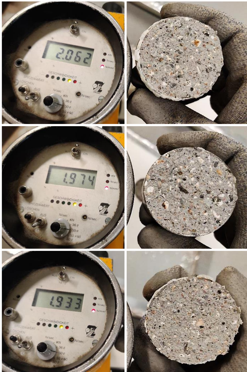
Kuva 9. Kuvasarja P5 tartuntavetolujuustuloksista ja murtokohdista.
