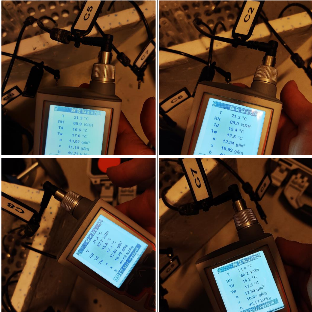
Kuva 5. Kuvasarja ennakkovaiheen P4 kosteusmittauksista pohjan kautta kerätyistä näytepa-loista.
