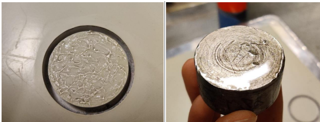
Kuva 15. Vasemmalla on vetoalueelle levitetty pikaliima ja oikealla vetonappiin on suihkutettu kiihdytintä.
