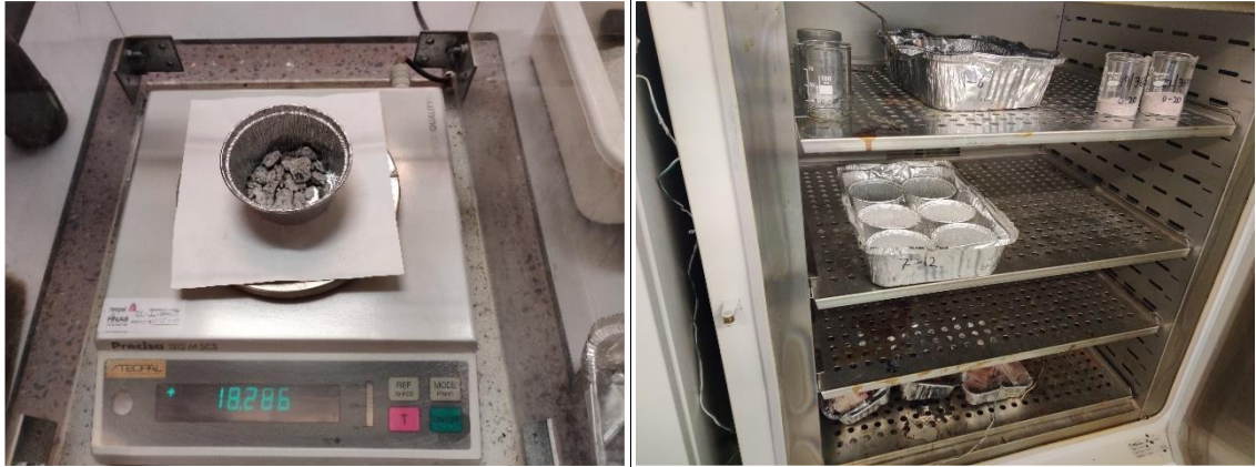
Kuva 13. Vasemmalla on kuvattu näytteen punnitus tarkkuusvaa'alla ja oikealla näytteet ovat kuivumassa lämpökaapissa kuivumassa. Kuivumisen jälkeen näytteet punnitaan uudelleen.
