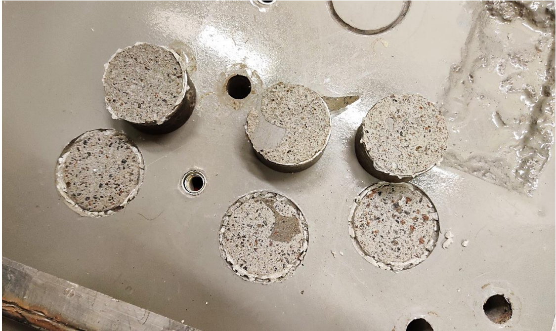
Kuva 6. Ennakkovaiheen P4 tartuntavetolujuuskokeiden (98 N/s) vetonapit ja murtoalueet vasemmalta oikealle: veto 1 (murto 98% A, 2% A/B), veto 2 (murto 85% A, 15% A/B) ja veto 3 (murto 95% A, 5% A/B).
