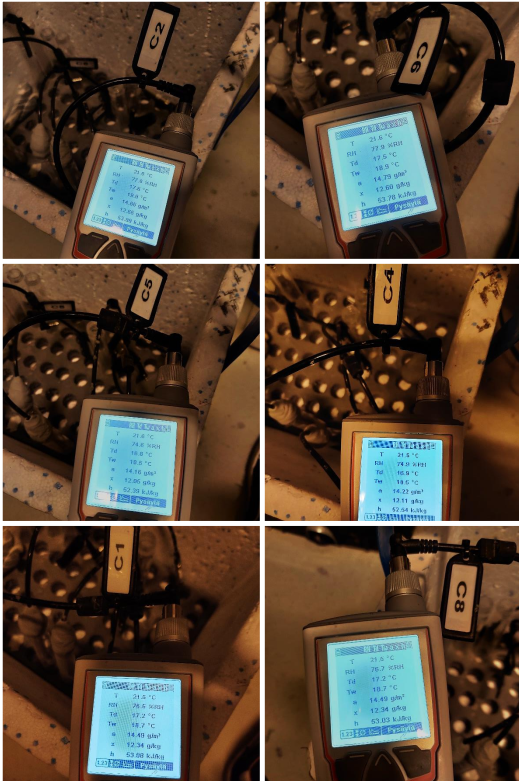
Kuva 1. Kuvasarja ennakkovaiheen P2 kosteusmittauksista pinnan kautta kerätyistä näytepa-loista.
