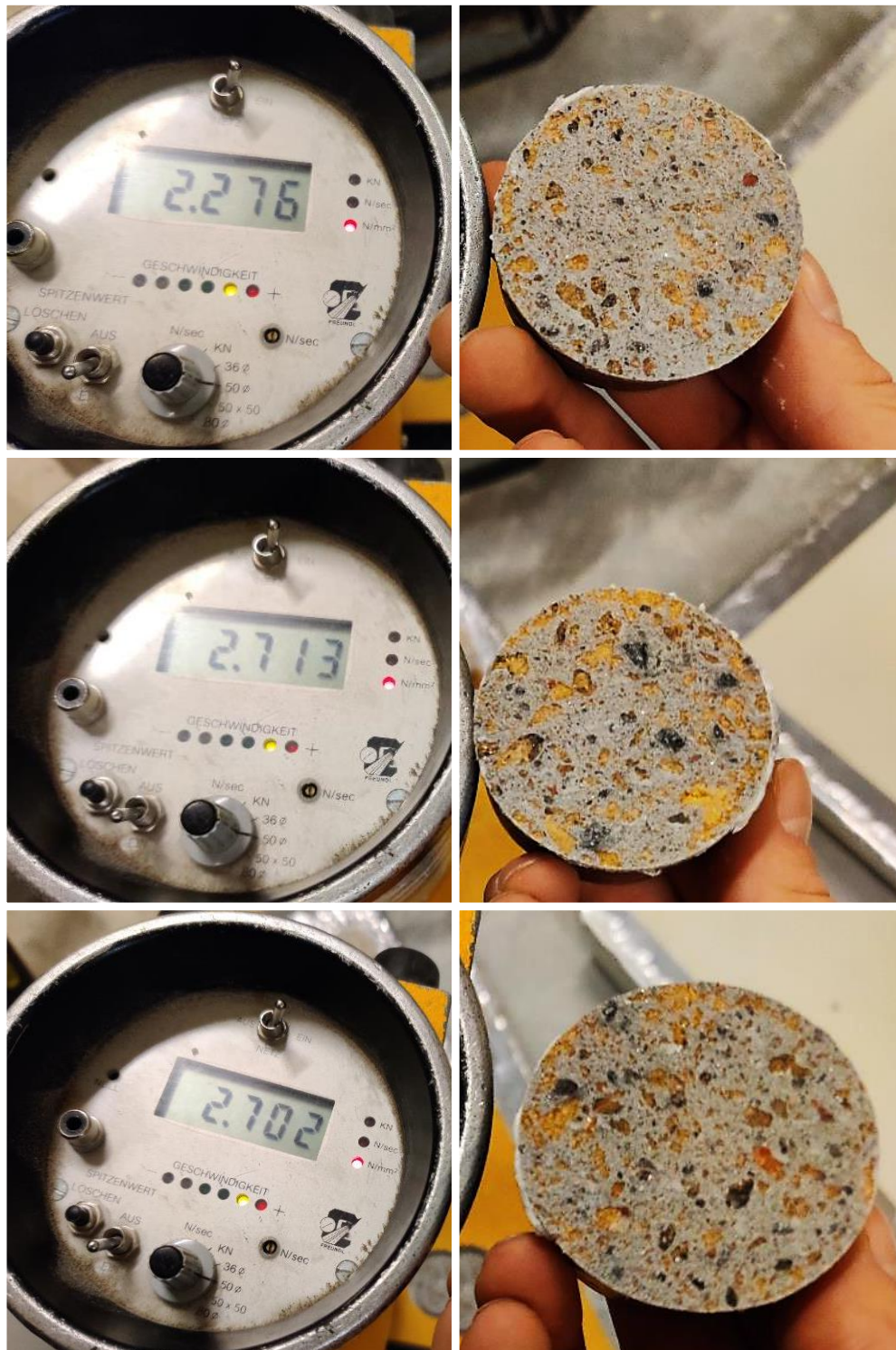
Kuva 11. Kuvasarja P6 tartuntavetolujuustuloksista ja murtokohdista.
