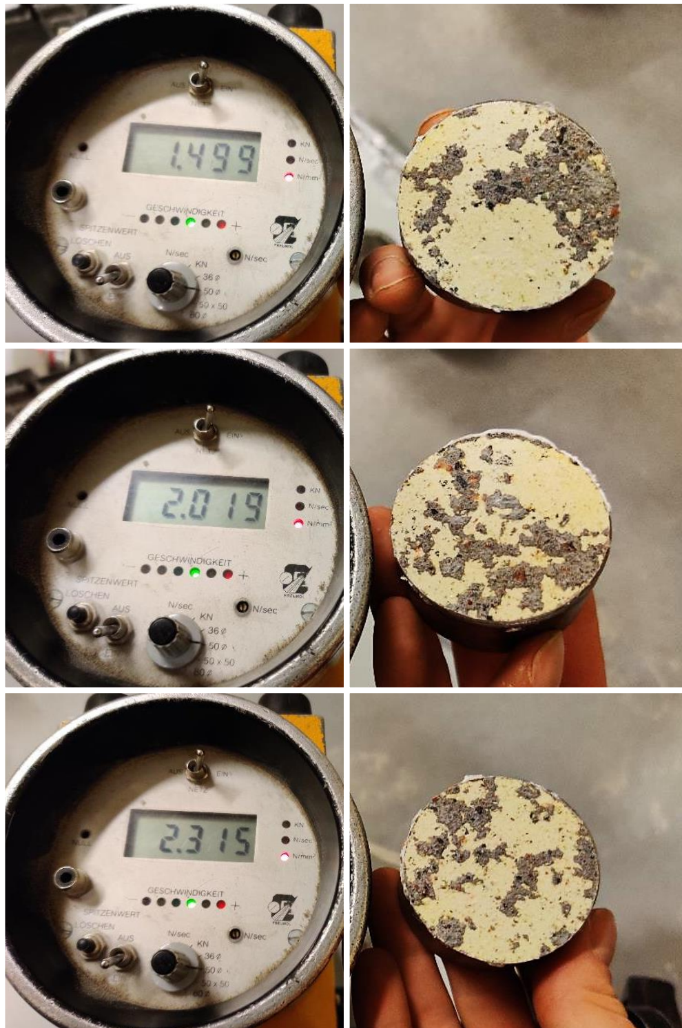
Kuva 13. Kuvasarja P7 tartuntavetolujuustuloksista ja murtokohdista.
