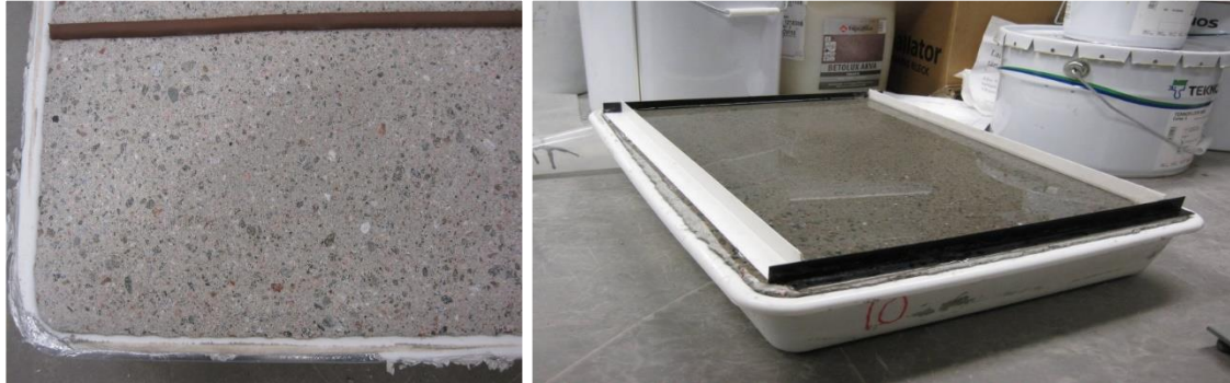
Kuva 7. Vasemmalla on esitetty timantilla pinnasta hiottu koekappale, josta sementtiliima on poistettu kokonaan ja silmämääräisesti arvioiden noin 1/3 runkoaineen maksimirakkoista on näkyvillä. Oikealla kuvassa on näkyvissä koekappaleen päällä pidetty vesipatja kaukalossa kosteustapauksissa kasteltu ja märkä. [8.]
