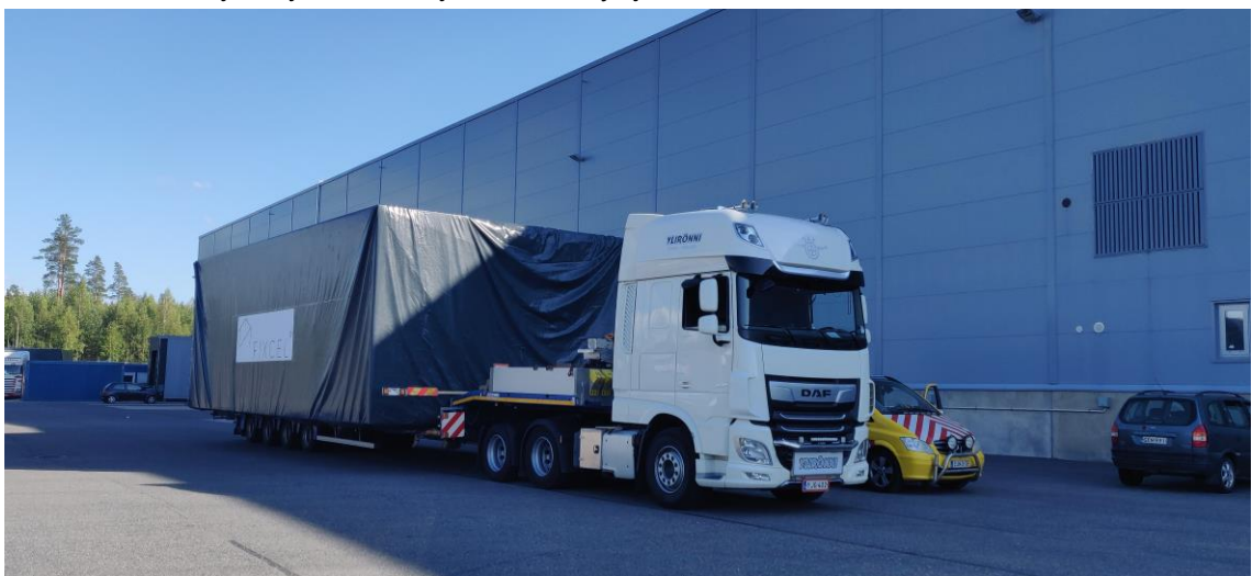
Kuva 10. Moduulien kuljetus työmaalle vaatii rekalle etu- ja taka-auton
