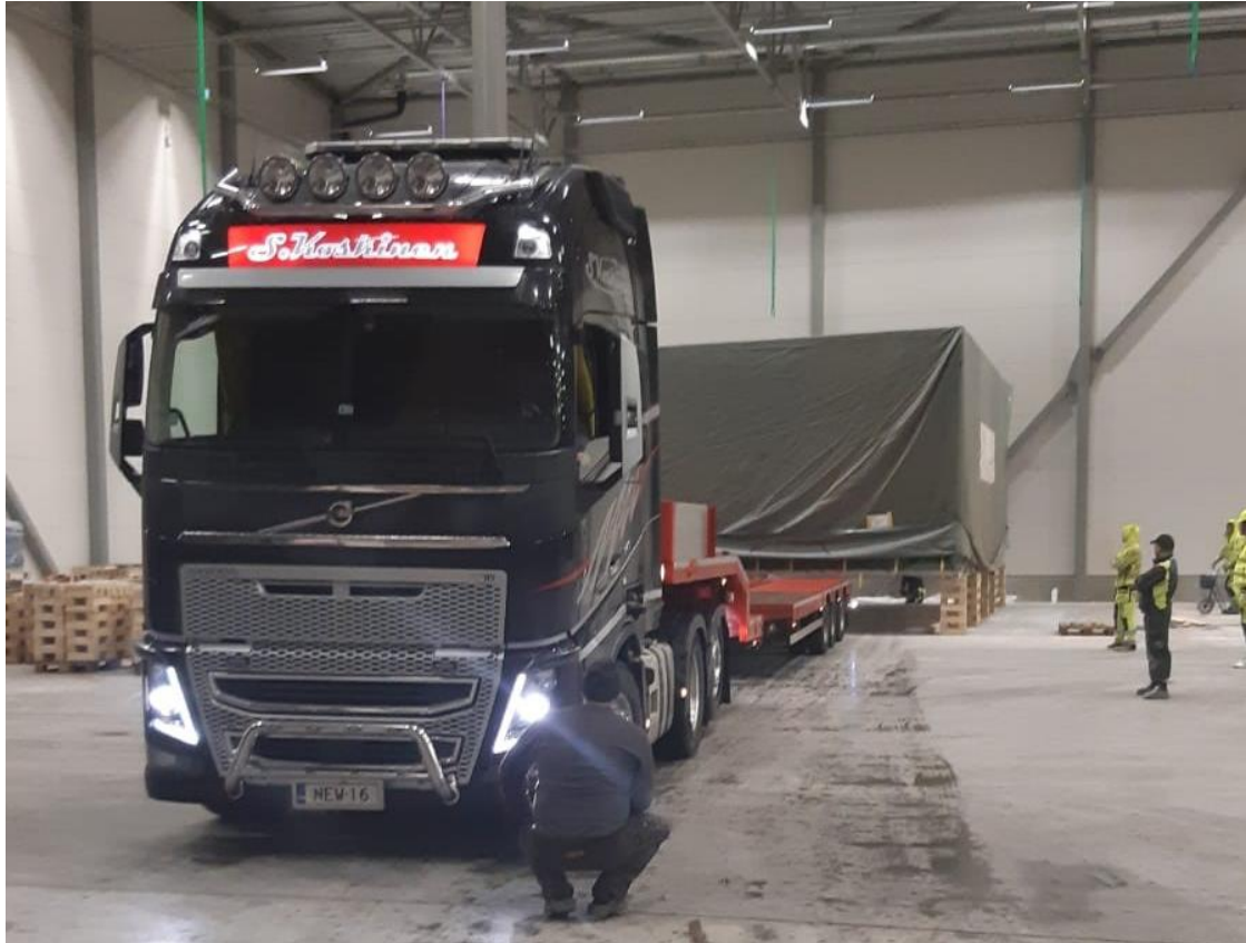
Kuva 9. Lavetti peruutetaan moduulin alle ja nostetaan paineilmajousilla ylös
