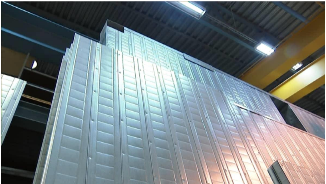
Kuva 5. Teräskennon pinnassa näkyy työstöjäljet sekä niittaus
