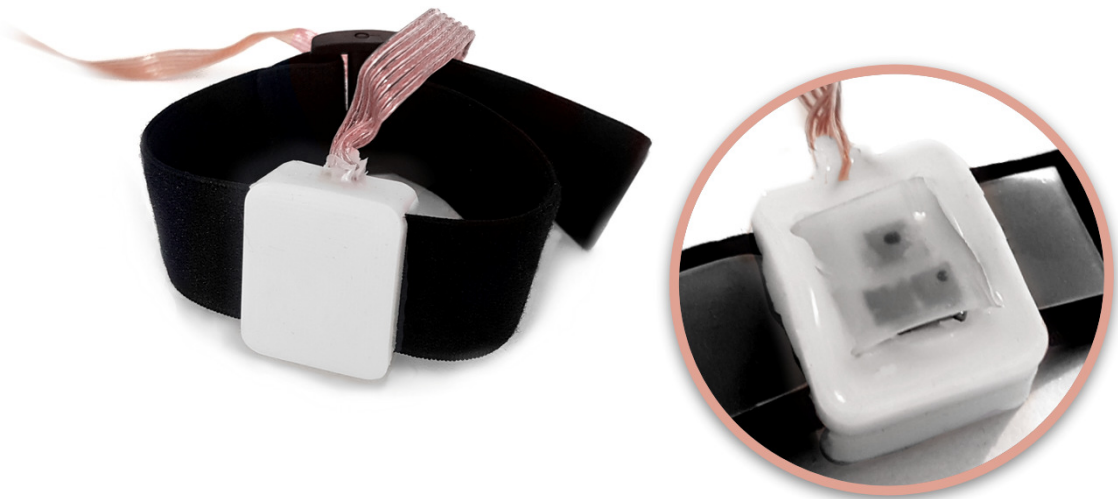
Kuva 19. Verenpainemittariprototyyppi. Oikealla sen kääntöpuoli, jossa on rannetta vasten asetettava silikoniliuska ja sen alla olevat paineanturit.
