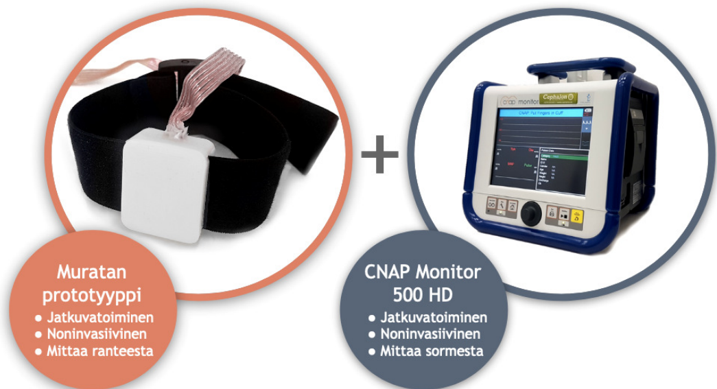
Kuva 29. Verenpainetiedon keräykseen käytetyt laitteet. Vasemmalla Muratan prototyyppi ja oikealla CNAP Monitor 500 HD.
