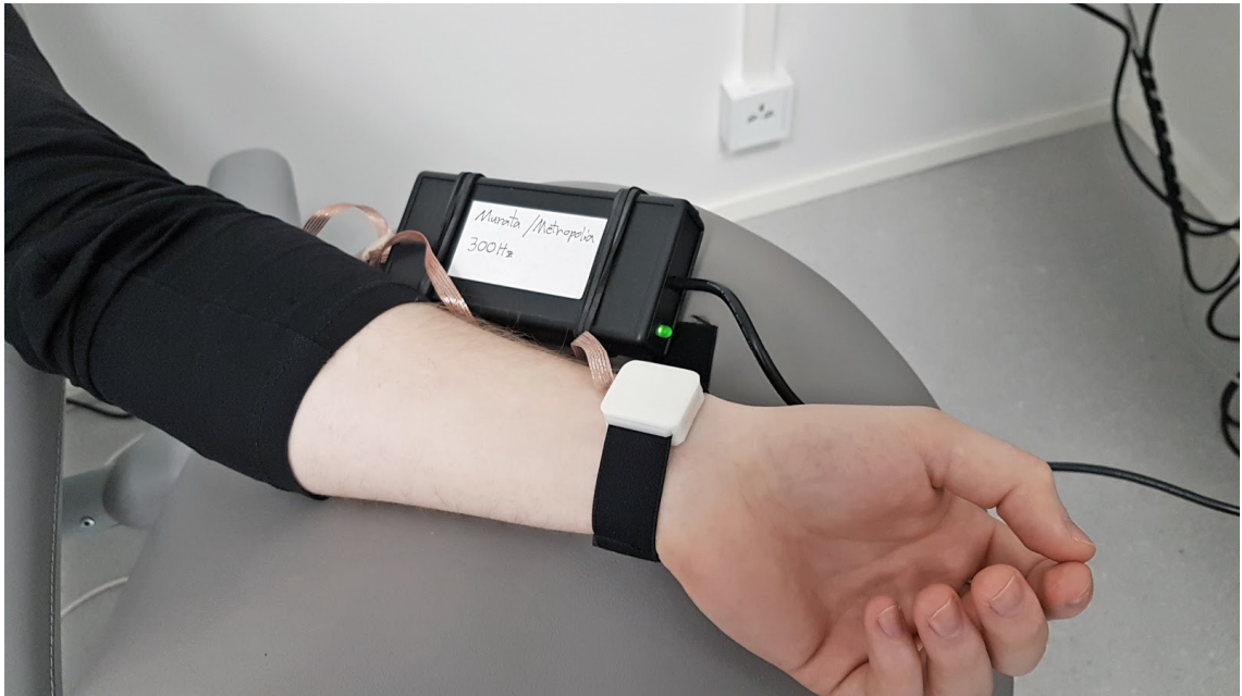
Kuva 32. Prototyypin kiinnitys tutkittavan vasempaan käteen ja ranteen asento.
