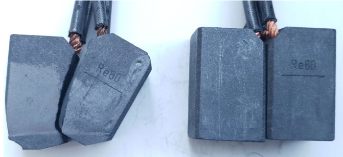
Kuva 13 Vasemmalla kuluneet hiilet, oikealla uusi hiilipari.
