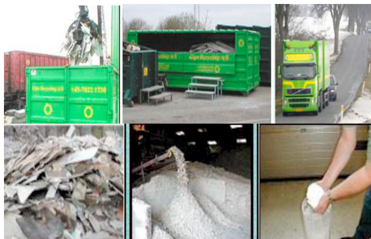
Figure 3.7 Plasterboard recycling (Kuosa, 2012)
