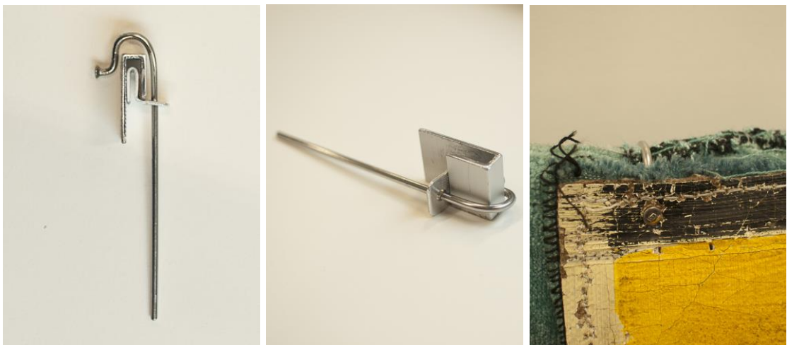
Kuva 60. Vasen ja keskimmäinen, J-lista, L-kiinnike ja taivuteltu rosteripinna.
