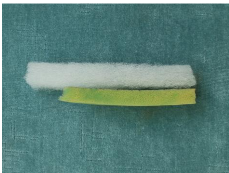
Kuva 41. Ylempänä 20 mm vanulevy ja alempana 10 mm vaahtomuovi.
