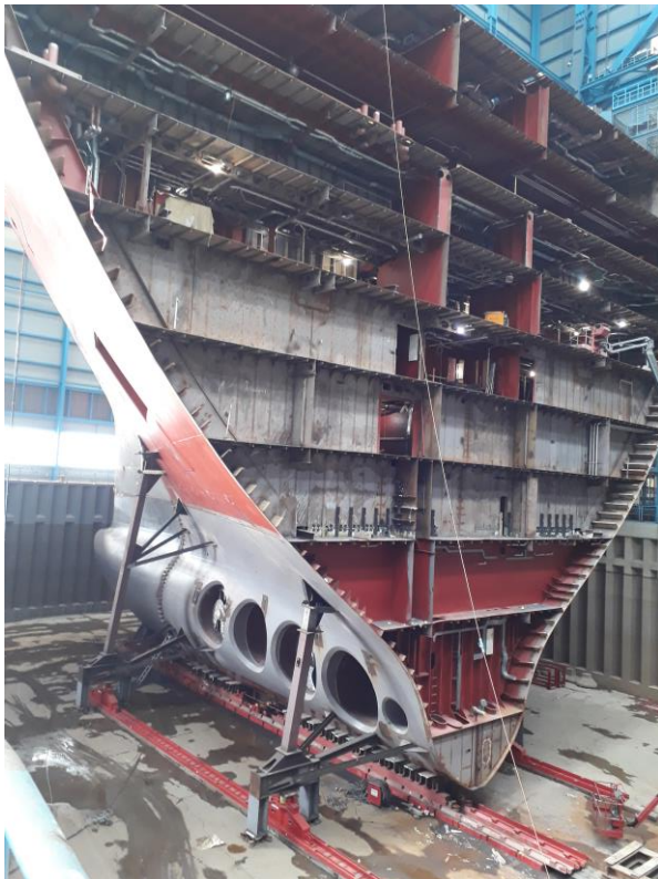
Kuva 2. Risteilyaluksen keulapala. Kuvassa näkyvät neljän keulapotkurin paikat.
