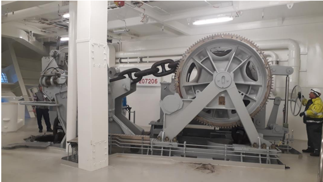
Kuva 28. Ankkuripeli/-vinssi 337m pitkässä risteilylaivassa (MacGregor 2020).
