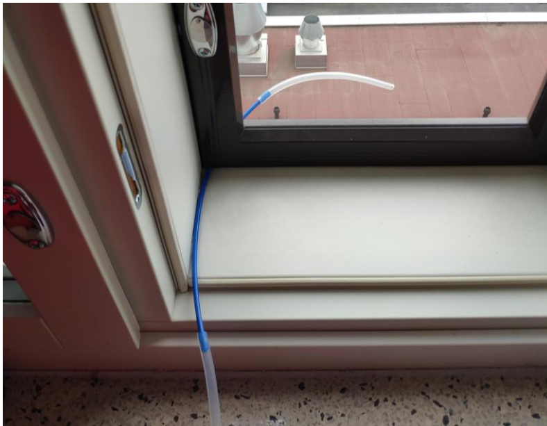
KUVA 16. Sininen pneumatiikkaputki tuuletusikkunan läpi
