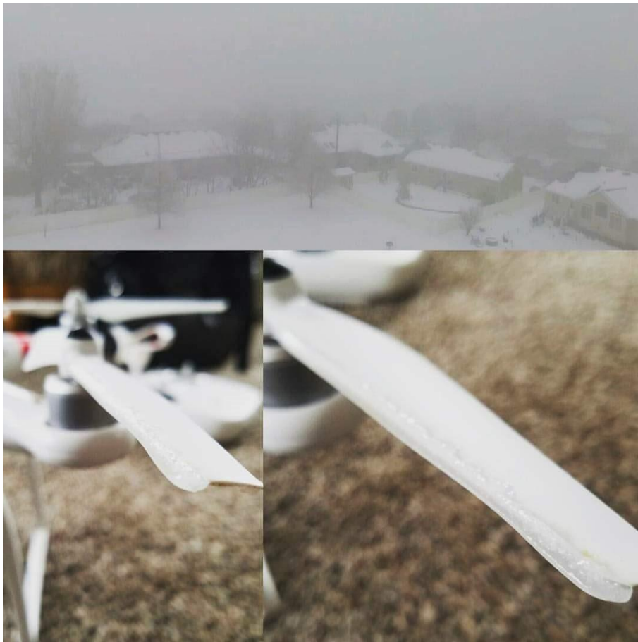
KUVA 3. Pyöriväsiipisen ilma-aluksessa sumun aiheuttamaa jääkerrostumaa (Decker 2017)
