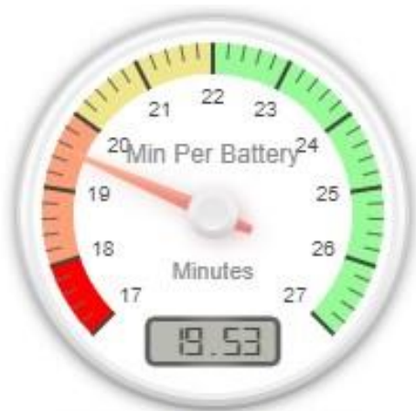
KUVIO 12. Arvioitu jäljellä oleva lentoaika ilma-aluksen lavat jäätyneenä ja akun varauksen ollessa lähdössä 88% (Airdata-sovellus)
