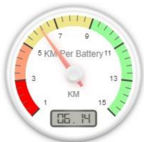
KUVIO 14. Arvioitu jäljellä oleva lentomatka lavat puhtaina lentonopeuden ollessa 10m/s ja akunvaraus lähdössä 85% (Airdata-sovellus)
