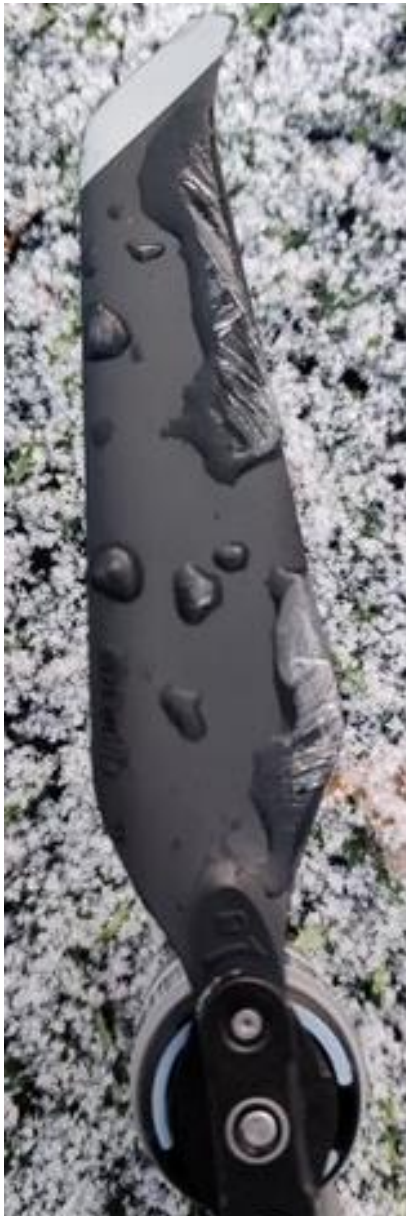
KUVA 6. Toisena mittauspäivänä aikaan saatu lavan jäätyminen
