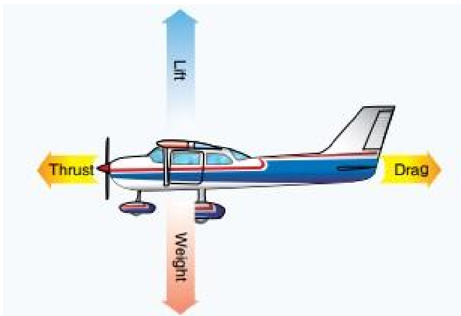
KUVIO 1. Ilma-alukseen vaikuttavat voimat (Pilot's Handbook of Aeronautical Knowledge 2016, 5-2)
