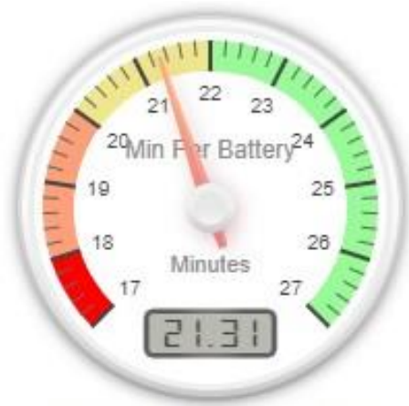
KUVIO 11. Arvioitu jäljellä oleva lentoaika ilma-aluksen lavat jäätyneenä ja akun varauksen ollessa lähdössä 97% (Airdata-sovellus)
