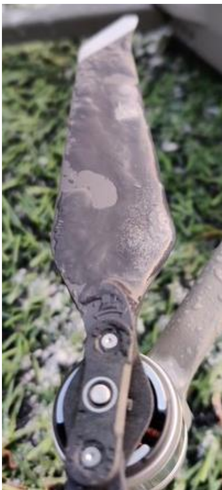
KUVA 5. Jääkerros potkurin lavassa ensimmäisenä mittauspäivänä
