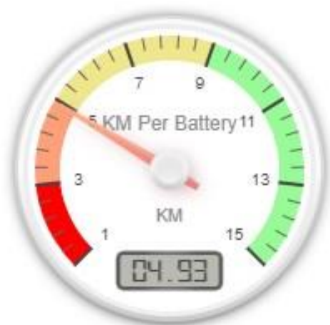
KUVIO 13. Arvioitu jäljellä oleva lentomatka lavat puhtaina lentonopeuden ollessa 5m/s ja akunvaraus lähdössä 92% (Airdata-sovellus)
