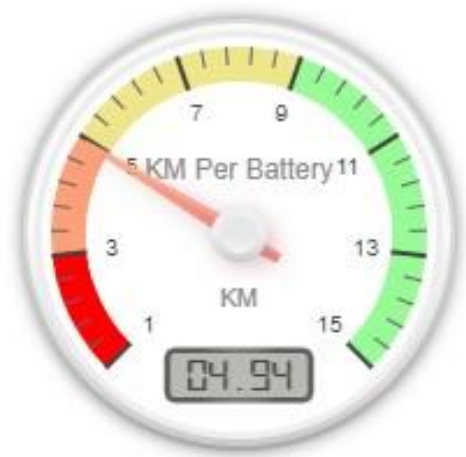
KUVIO 16. Arvioitu jäljellä oleva lentomatka lavat jäätyneenä lentonopeuden ollessa 10m/s ja akunvaraus lähdössä 92% (Airdata-sovellus)
