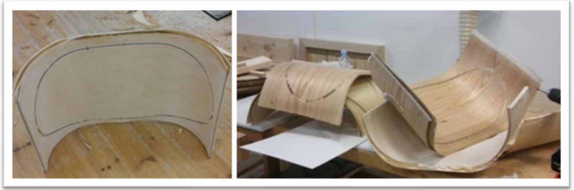
Kuva 37 Muotopuristeaihiot CNC-jyrsinnän jälkeen. Istuinosaat ovat vielä kiinni aihioissa. (Köckritz 2019.)
