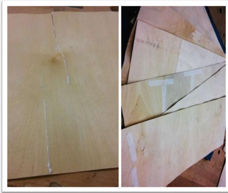
Kuva 23 Viilujen korjaamista liimaamalla ja teippaamalla (Köckritz 2018)
