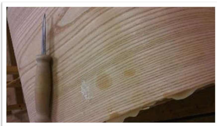
Kuva 34 Urealiimajälkiä aihion pinnassa. Aihion reunalla ollut liima jäi vain osin jyrsettyn, valmiiseen muotopuristeeseen. (Köckritz 2019.)
