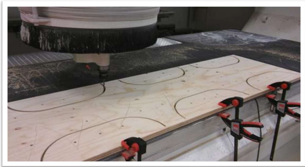
Kuva 17 Puristimet varmistavat levyn paikallaan pysymisen jyrsinnän aikana (Köckritz 2018).
