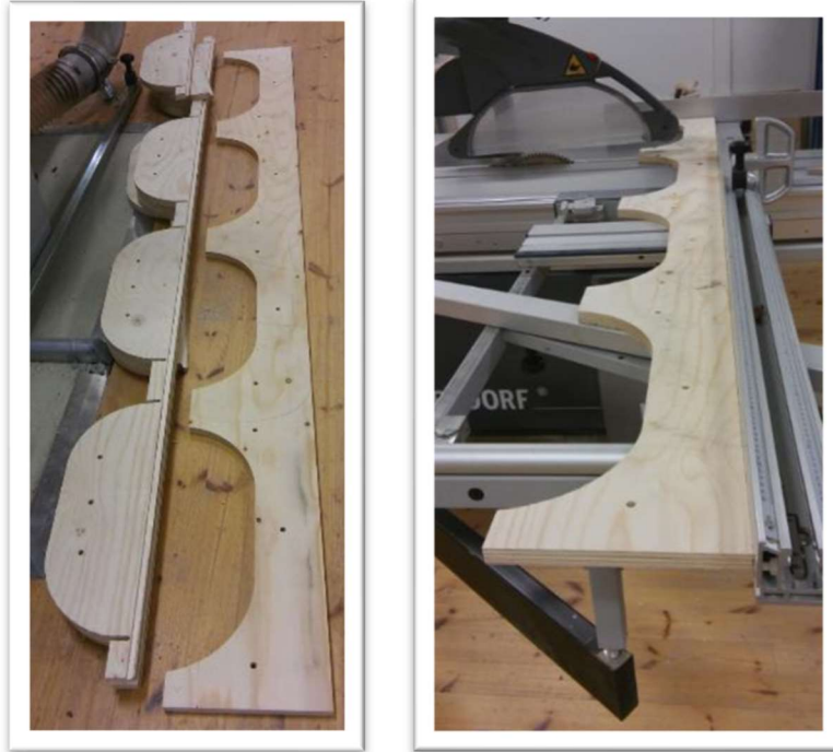
Kuva 18 Muotin osat CNC-jyrsinnän jälkeen (Köckritz 2018)
