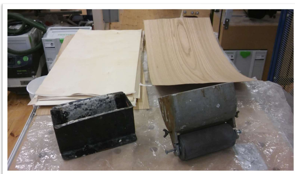
Kuva 30 Viilunippu tarkistettu ja ladottu valmiiksi liimausta varten (Köckritz 2018)
