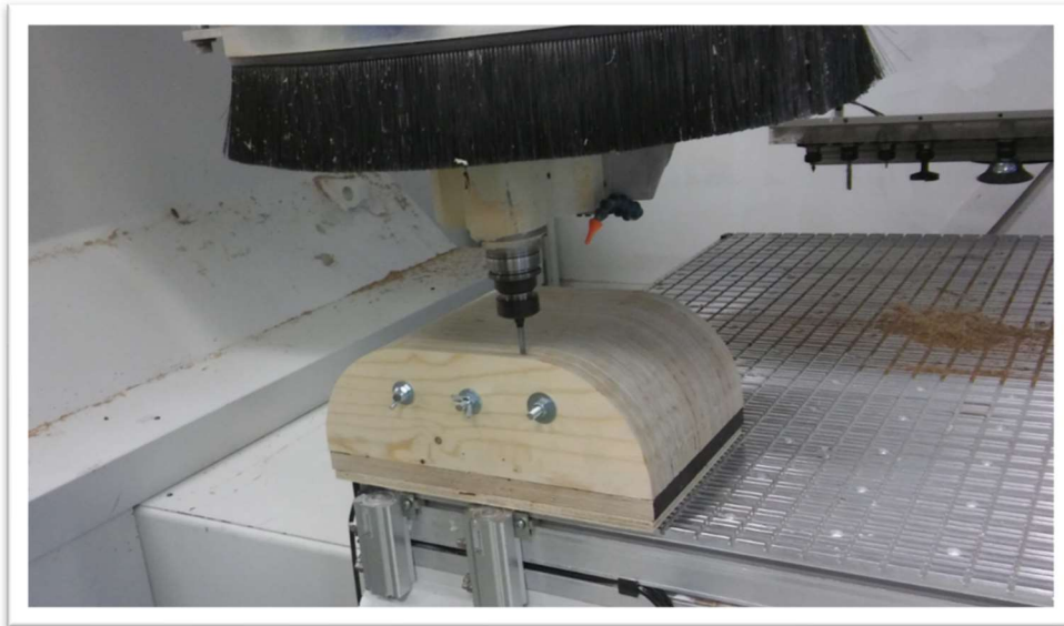
Kuva 36 Istuinosen CNC-jyrsinnän testiajo, jossa tarkastettiin jyrsimen liikerata ja kohdistus ennen aihoiden kiinnitystä. Kylmäpuristusmuotin kansiosaa käytettiin aihoiden tukena istuinosen jyrsinnässä. Aihion tarkka kiinnitys on edellytys onnistuneelle jyrsinnälle. (Köckritz 2019.)
