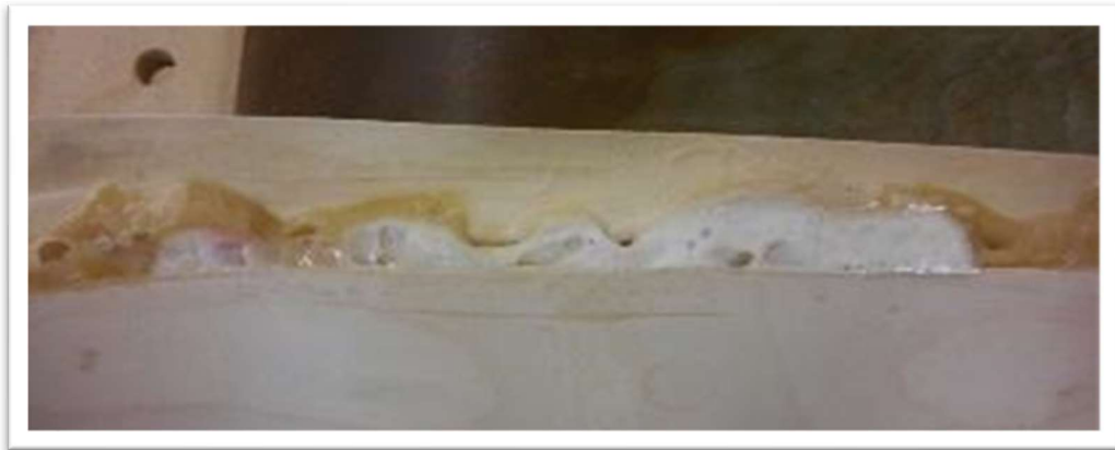
Kuva 33 Ylimääräinen liima puristuu viilujen välistä. Kuvasta on havaittavissa urealiiman turpoaminen kuplimisena sen kovettuessa. (Köckritz 2018.)
