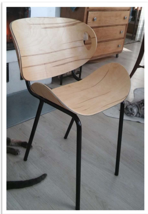
Kuva 53 Koivupintainen koeversio tuolista. Tuolia käytettiin kotiloissa. Se kesti arkipäiväistä käsittelyä hyvin. Selkänöjan kiinnitys oli jäänyt liian alas ja se alkoi tuntua epämiellyttävältä hetken istumisen jälkeen. (Köckritz 2019.)
