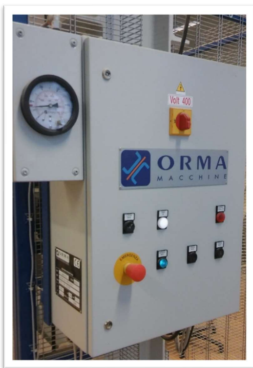
Kuva 26 Hydraulipuristimen puristuspaineen asetus- ja osoitusnäyttö sekä käyttöpainikkeet. (Köckritz 2018)
