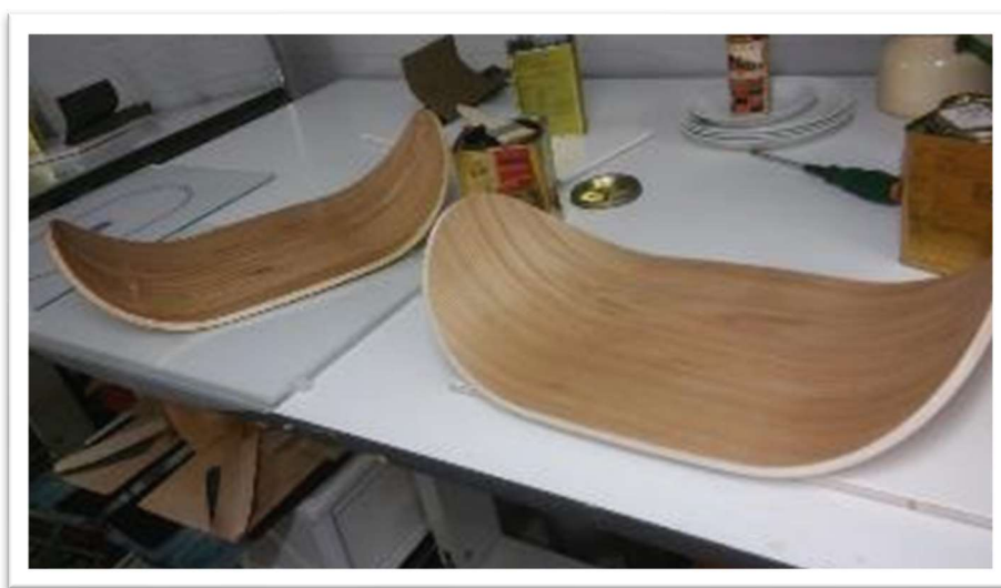
Kuva 39 Rekonstruktion jalavapintaisten istuinosaisten lakkaukseen LeTonkinois-lakalla (Köckritz 2019)
