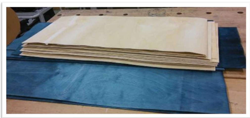
Kuva 24 Perinteisen koivuviilun lisäksi harjoituskappaleissa käytettiin siniseksi läpivärjättyä CWP-koivuviilua. Viilu toimi erinomaisena merkinä eri puristekokeilujen tunnistamisessa ja ladonnan suunnan osoittajana. Siniset viilut olivat puristeissa aina ladotut pituussuuntaan. (Köckritz 2018.)
