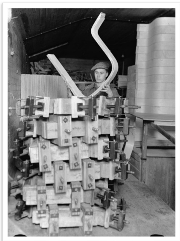
Kuva 3 Huonekalu- ja rakennustyötehdas Korhonen. Työkuva. Muotopuristeiden tekoa. Kuvaaaja Mauno Mannelin. Kuvattu 1930-luvulla. (Finna.fi 2020a.)
