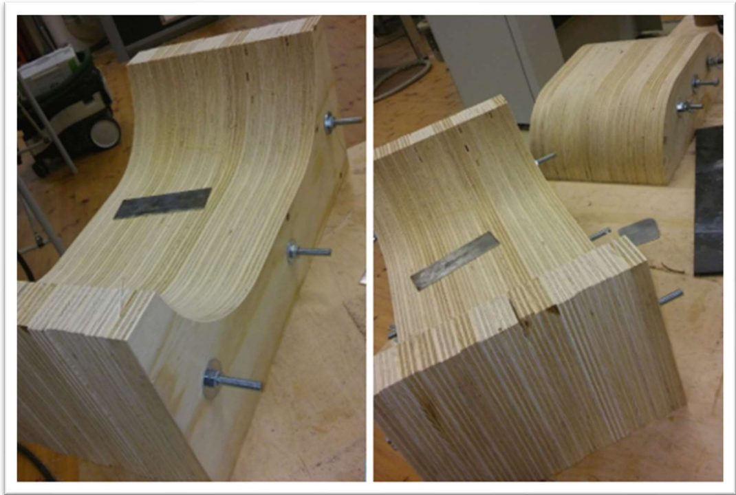
Kuva 21 Muotin pinnat viimeisteltiin siklillä eli teräslevystä tehdyllä kaavintyökalulla. Siklillä saatiin kaarevasta pinnasta tasattua muottiosien saumat. (Köckritz 2018.)
