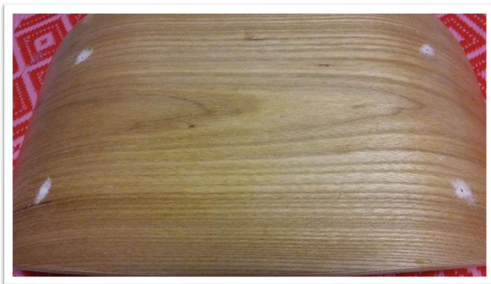
Kuva 52 Istuinosaan pohjaan valmiiksi poratut esireiät ruuveille. Porauspöly imuroitiin pois. (Köckritz 2019.)
