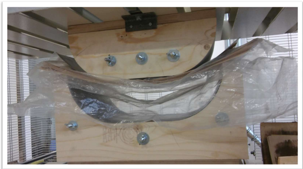
Kuva 31 Viilunipun puristus hydraulipuristimessa. Muotin yläosaan oli lisätty korotuspala liikumisvaran kasvattamiseksi. Kookkaat suojamuovit viilunipun ja muottipeltien välissä vaativat oikomista. Puristin laskettiin alas vähän kerrallaan. Samalla varmistettiin viilunipun paikallaan pysyminen. (Köckritz 2018.)
