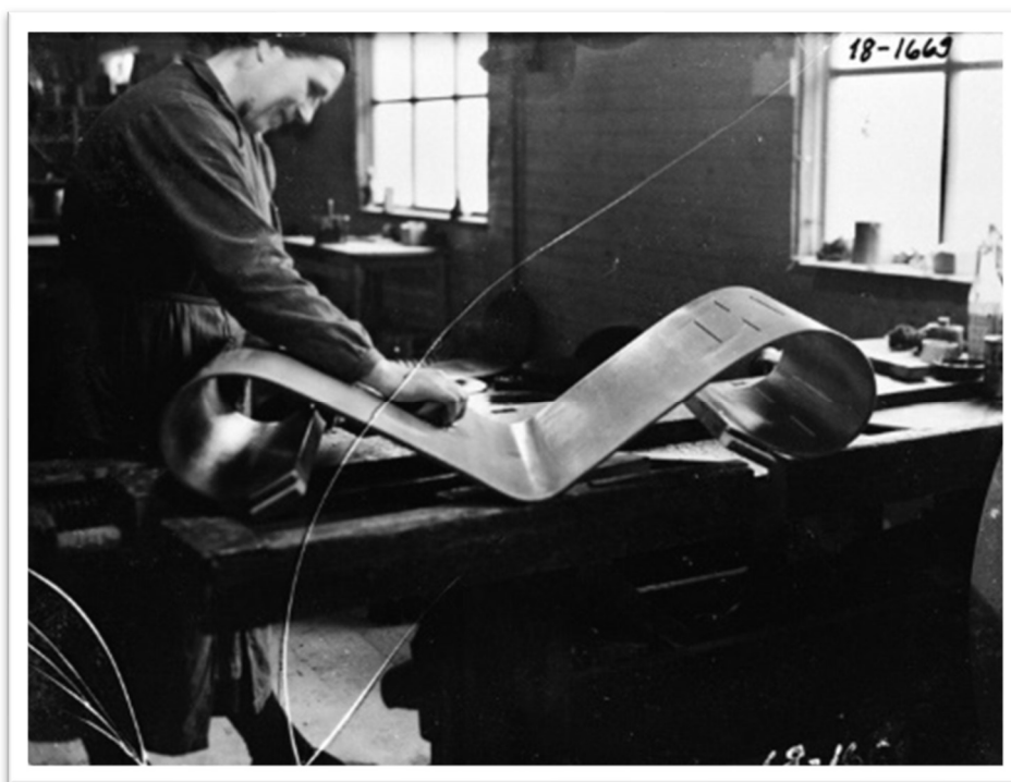
Kuva 5 Työkuvaa. Paimion parantolassa käytetyn nojatuolin istuinosaa hiotaan Huonekalu- ja rakennustyötehdas Korhosen tehtaalla. Kuvaaja Mauno Mannelin. Kuvattu 1930–1939. (Finna.fi 2020b.)
