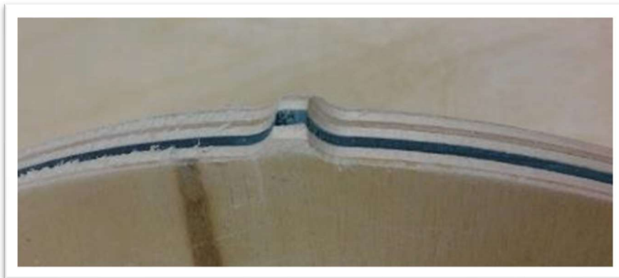
Kuva 38 listuinkappaleiden kiinnikekohdat paikoissa, joissa CNC-jyrsinterä nousi aihioista. Kohdat hiottiin pois. Istuinkappaleessa nähtävissä keskellä sininen CWP-viilukerros ja pinnassa pieniä jyrsinnän aiheuttamia viulun repeämiä. (Köckritz 2019.)
