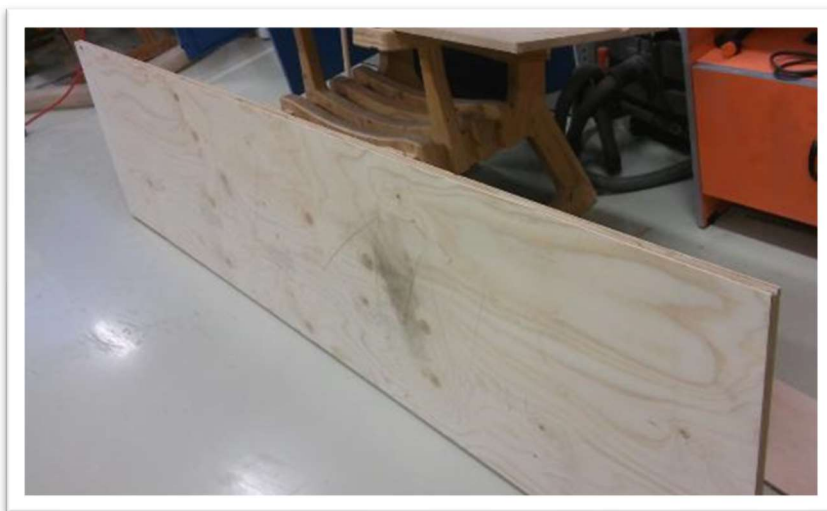
Kuva 13 Koon 600 x 2440 x 21 koon havuvanerilevyt odottamassa CNC-työstöä (Köckritz 2018)
