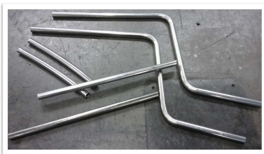
Kuva 44 Rekonstruktion rungon kappaleet määrämittaam sahattuina sekä taivutettuina (Köckritz 2018)
