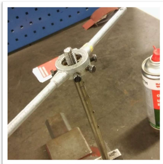
Kuva 20 Kierretangot valmistettiin terästangosta kierreväntimellä käsin. Voiteluöljy helpottaa kierteiden tekemistä ja vähentää väntimen kulumista. (Köckritz 2018.)
