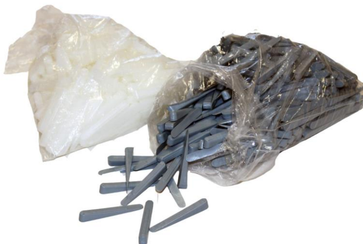
Kuva 14. Harkkojen asemointiin tarkoitettuja kiiloja.
