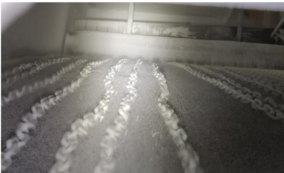
Kuva 11. Kiteen optimi levitys seulalle koko levityspellin leveydeltä.
