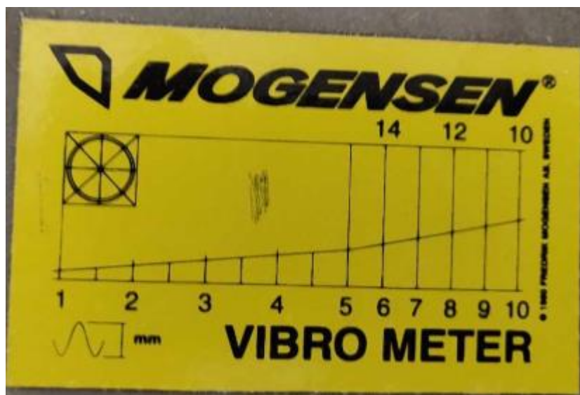
Kuva 9. Tärinämittarit sijaitsevat molemmilla puolilla seulaa.
