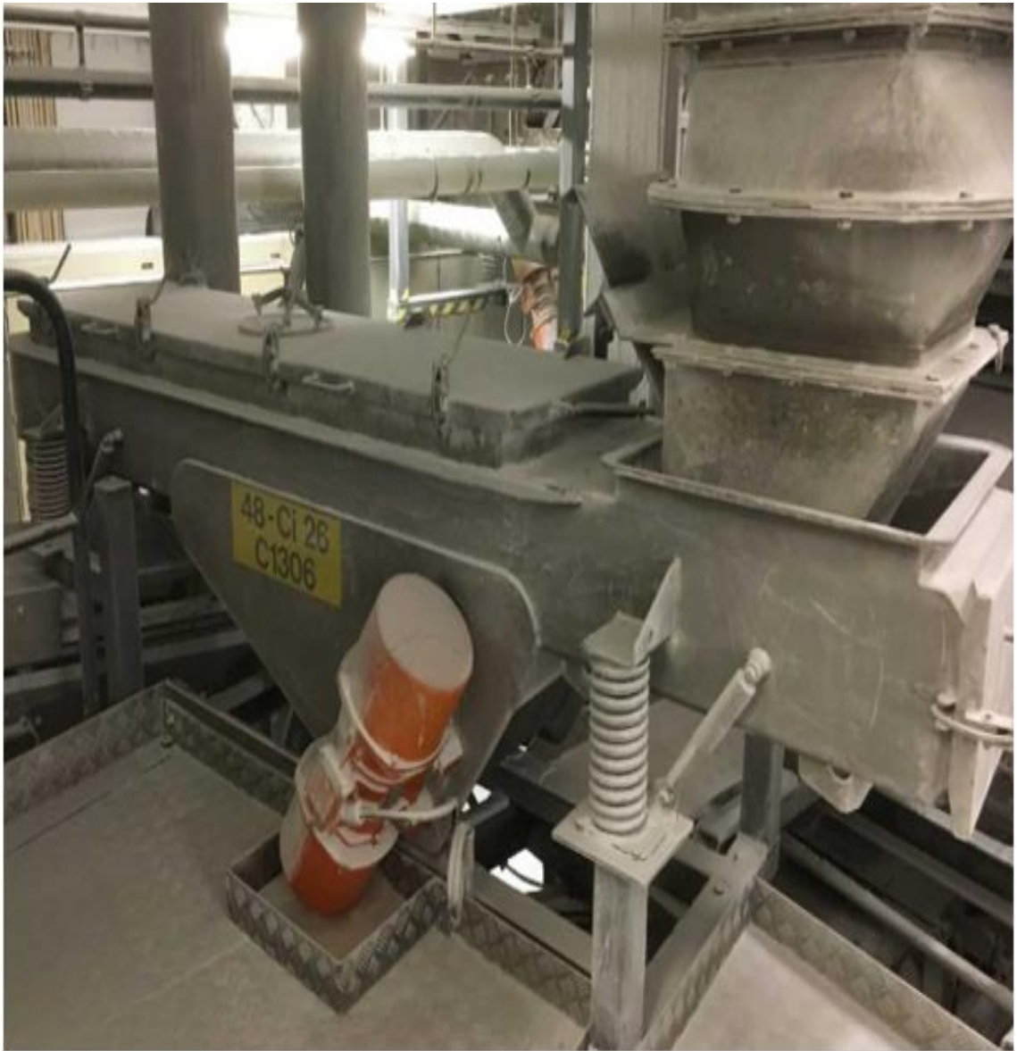
Kuva 10. Tärykuljetin, jolla säädetään seulaan menevän kiteen syöttövirtausta.
