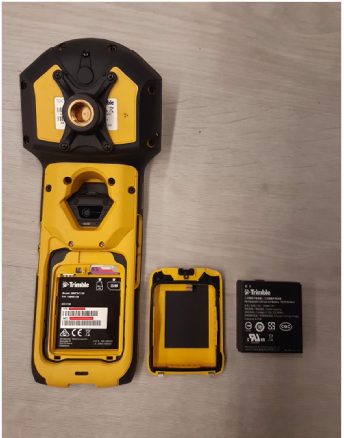
Kuva 6. TDC-150:n takakansi sekä akku irrotettu ja sim-kortti asetettu paikalleen.
