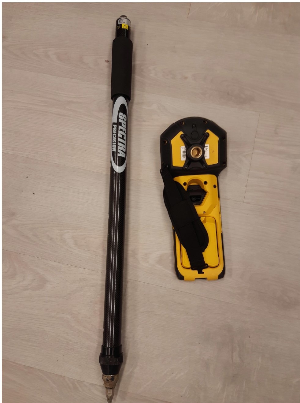
Kuva 7. TDC-150 ja siihen liitetty rannehihna ja sauvakiinnike. Laitteen vierellä hiilikuituinen teleskooppikartoitussauva.
