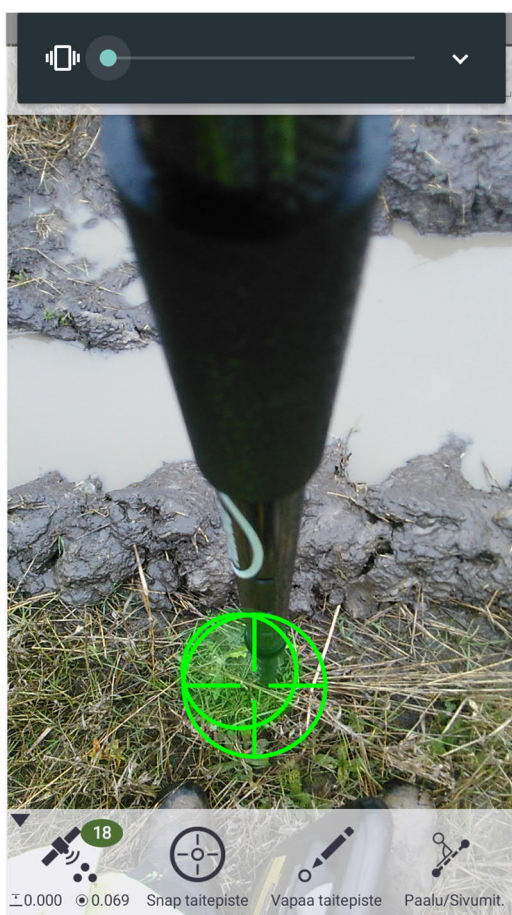
Kuva 29. TDC-150 GIS -laitteen kamera ja digitaalinen tasainyhdistelmä.
