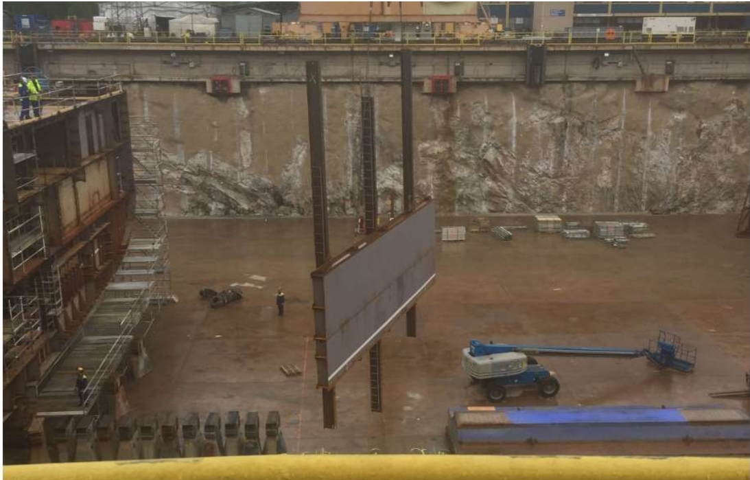
Kuva 25. Puskulevy nostetaan pois nosturilla (Meyer Turku 2019).
