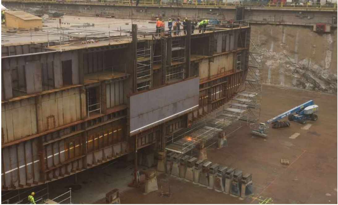
Kuva 24. NB-1394 FERUn Puskulevyn irrotus (Meyer Turku 2019).
