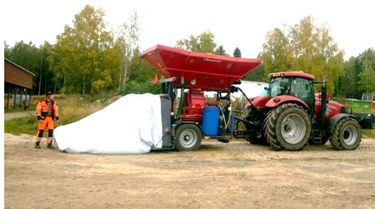
Nyss påbörjad packning av spannmål i slang
