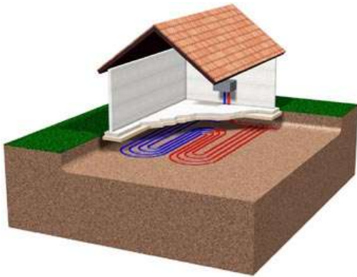
Bild 11. Installation under bottenplattan
