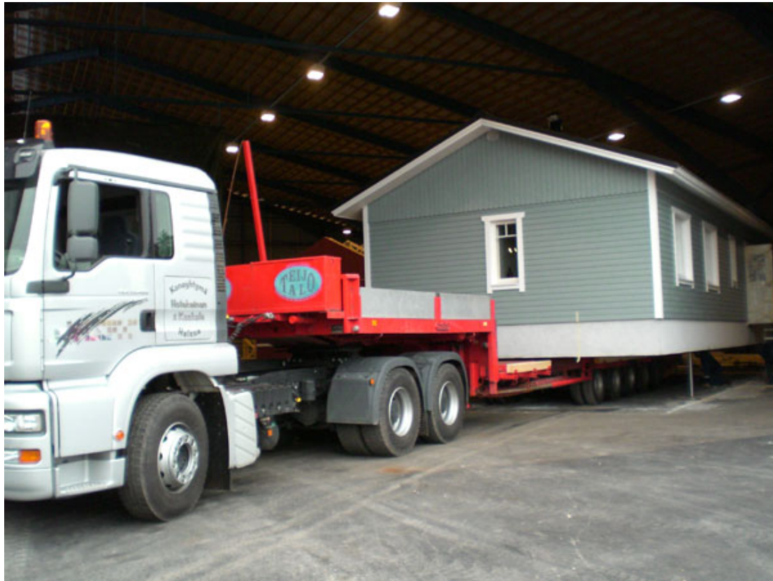
KUVIO 4. Kuljetuslavetin peruuttaminen valmiin talon alle tehtaalla. (Teijo-Talot 2010.)
