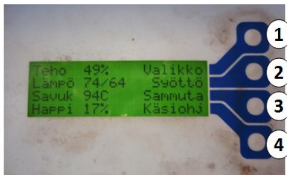
KUVIO 42. Kattilan ohjauskeskuksen automaattikäytön näyttö
