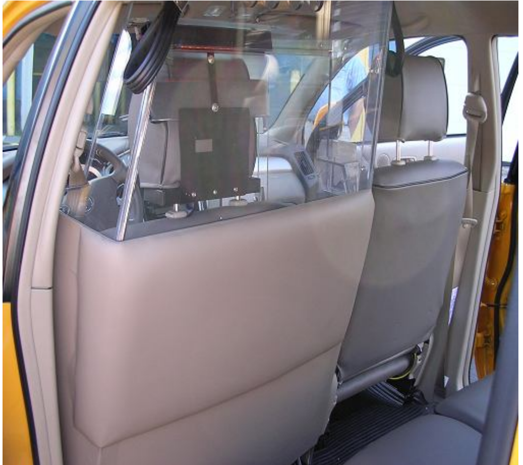
Kuva 12. New Yorkin taksin väliseinä polykarbonaatista
