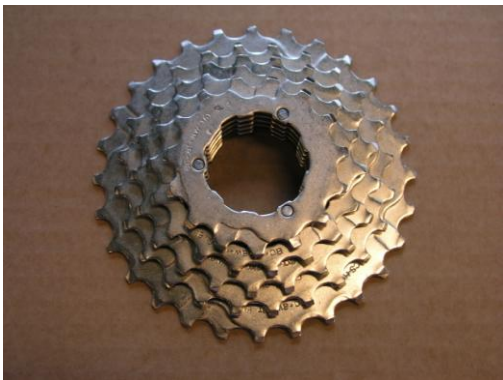
Kuva 9. 5-vaihteinen takarataspakka (T&K- laboratorio 5.4.2011)
