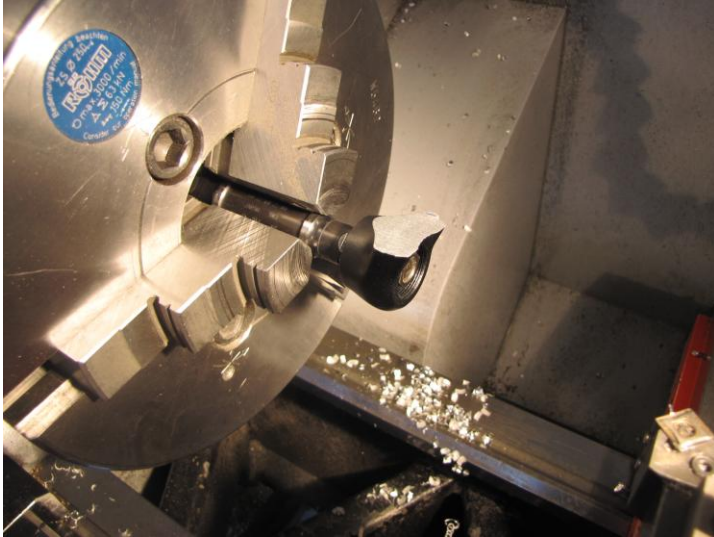
Kuva 19. Kammen pää kiinnitettynä sorviin keskiöakselin avulla (TAMK 22.3.2011)
