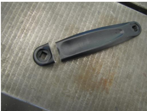
Kuva 18. Kampi, josta sahattu pää irti (T&K- laboratorio 22.3.2011)
