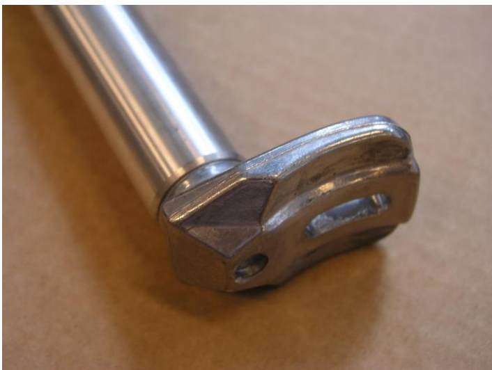
Kuva 27. Satulakiinnike, johon voima-anturi kiinnitetään (T&K- laboratorio 5.4.2011)
