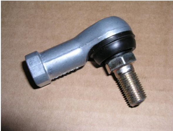
Kuva 28. Kulmanivel, jolla anturi kiinnitetään satulakiinnikkeeseen (T&K- laboratorio 5.4.2011)
