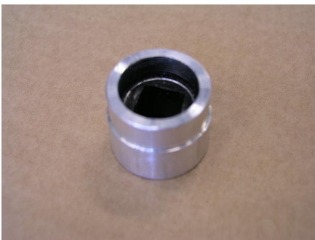
Kuva 20. Kammesta sorvattu lieriömäinen napa (T&K- laboratorio 5.4.2011)
