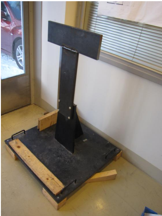
Kuva 12. Perämoottoriteline, josta runko valmistettiin (T&K- laboratorio 10.2.2011)
