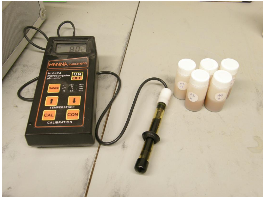
Kuva 8. Kloridipitoisuuskokeessa käytetty mittalaite ja näytteet.
